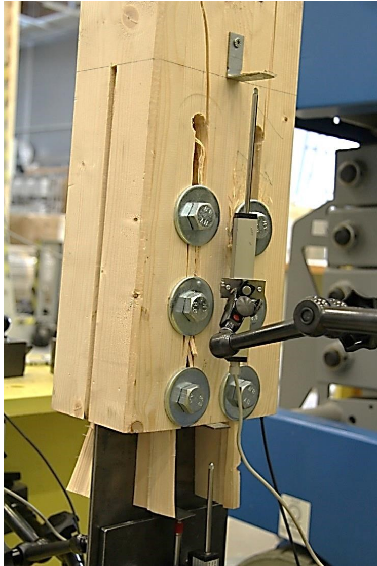
obr. 100 Fotografie spoje po ukončení zatěžovací zkoušky s omezeným rozsahem snímačů dráhy
