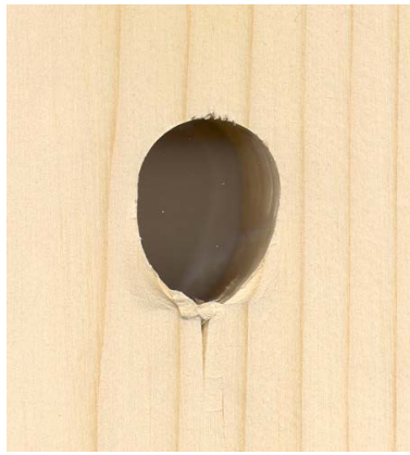
obr. 17 Zvětšení otvoru ve vzorku vlivem otláčení dřeva ve směru vláken a zároveň kolmo na vlákna [10]
