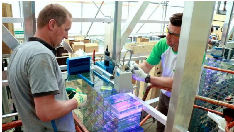
obr. 20: Technologie spojování skleněných cihel [27]
