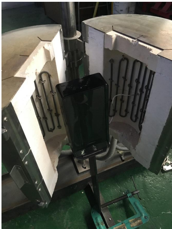
obr. 46: Zkouška skleněné cihly
