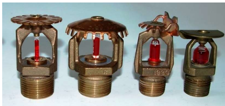
obr. 12 – Sprinklerové hlavice s rozdílným RTI [11] – skleněné baňky s průměrem (zleva) 3 mm (rychlá odezva), 4 mm (speciální odezva), 5 mm (standardní odezva A) a 8 mm (standardní odezva B)
