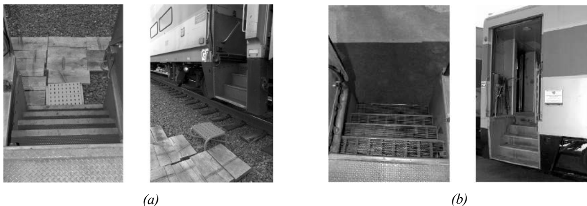
obr. 4 Výstup z vozu po schodišťových stupních: (a) na dlážděný povrch; (b) na úroveň terénu [9]
