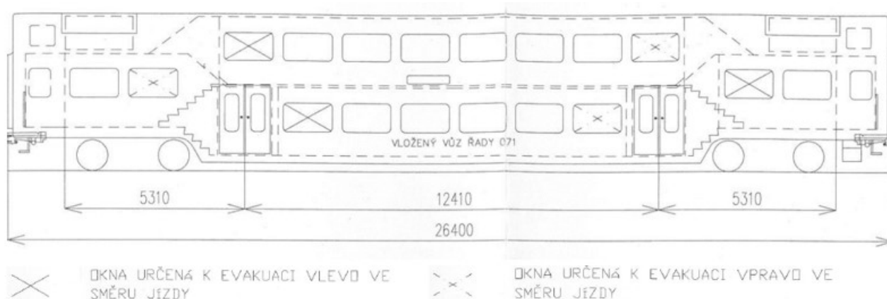
obr. 19 Výkres únikových cest předmětných jednotek; převzato a upraveno z [20] - Příloha 1
