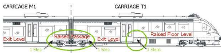
obr. 5 Úrovně podlahy ve vlakovém voze typu ETW [10]
