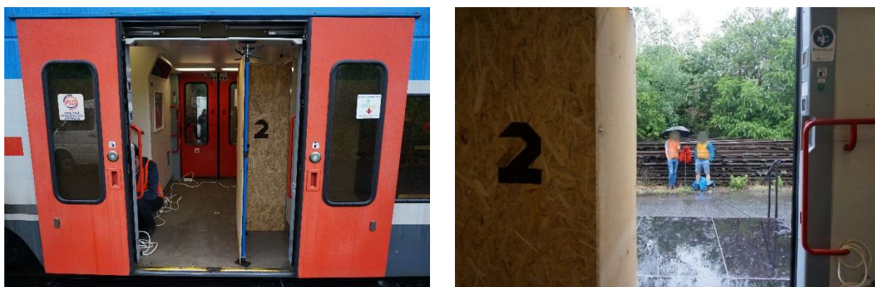
obr. 26 Bariéry zajišťující variabilitu vnitřního koridoru
