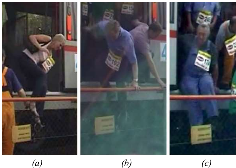
obr. 6 Strategie pro překonávání výškového rozdílu při výstupu z vlaku: (a) „Jumper“; (b) „Sider“; (c) „Sitter“ [11]
