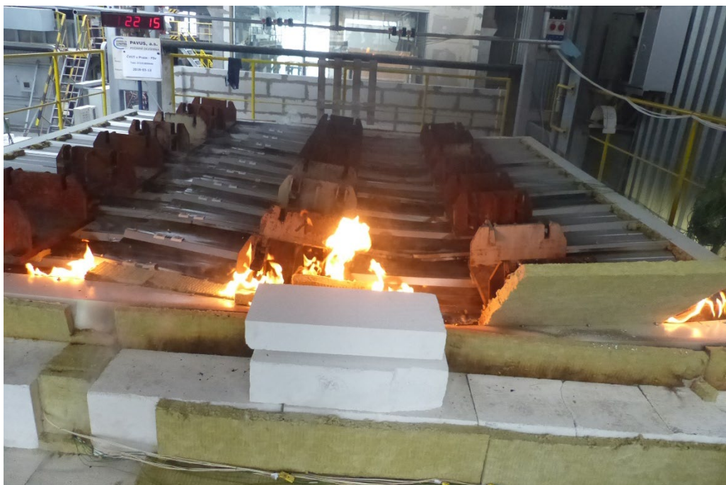
obr. 35 Prošlehnutí plamene na více místech
