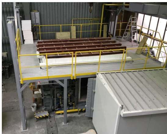
obr. 9 Horizontální pec ve Veselí nad Lužnicí PAVUS a.s. [8]
