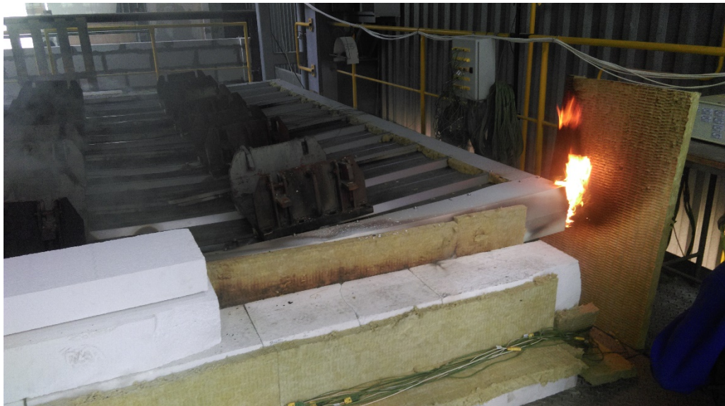
obr. 34 Prošlehnutí plamene v 63. minutě
