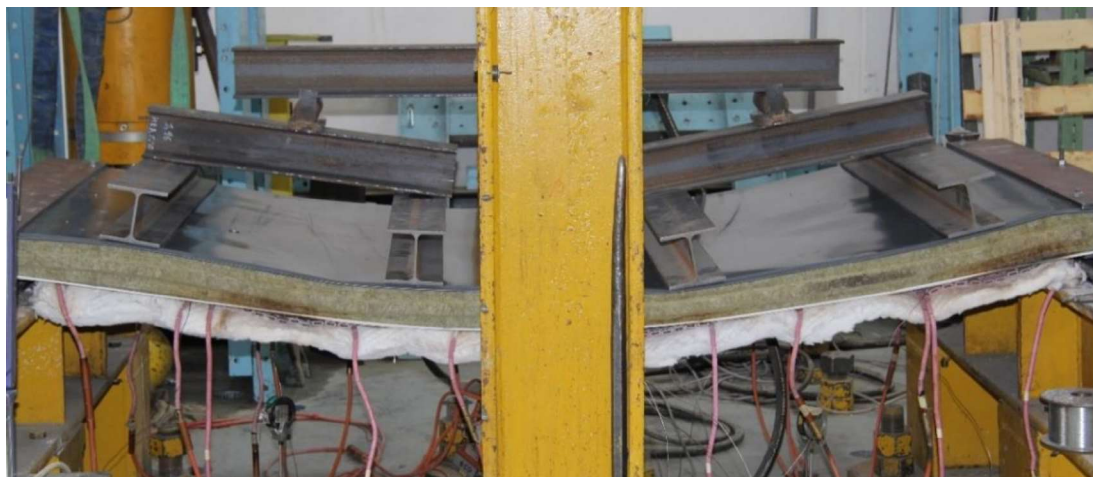
obr. 51: Sendvičový panel SPA 100 E po experimentu - 600 °C
