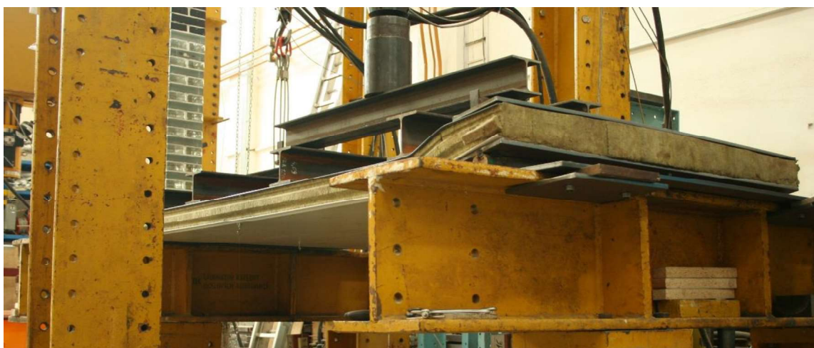
obr. 42: Vzorek během experimentu SPA 100E při běžné teplotě - zvětšení deformací
