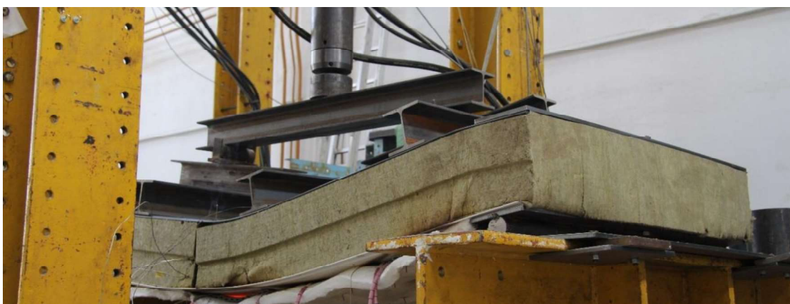
obr. 73: Sendvičový panel SPA 230 E během experimentu - 600 °C (rozšíření praskliny)
