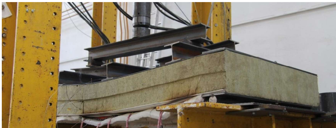
obr. 72: Sendvičový panel SPA 230 E během experimentu - 600 °C (vznik praskliny)
