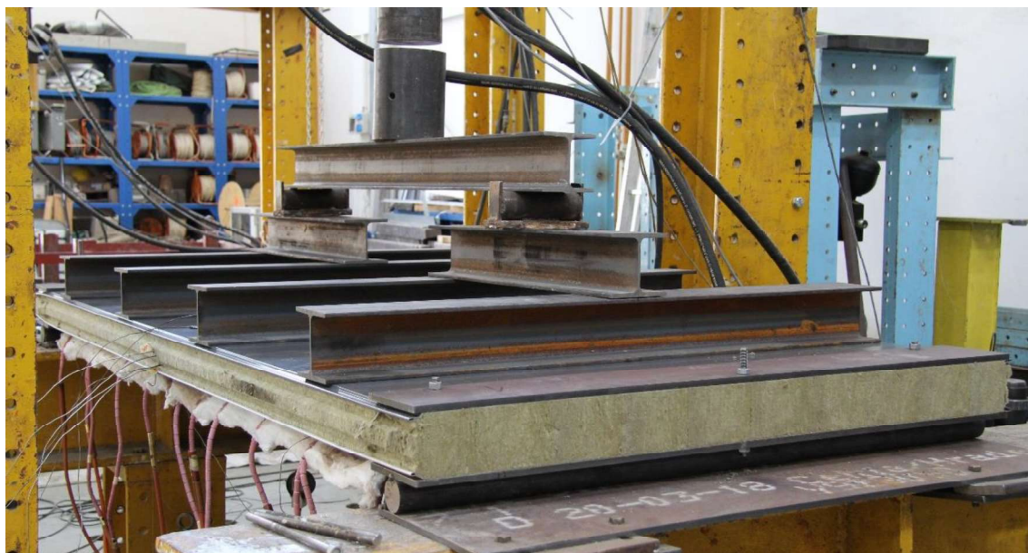
obr. 44: Zkušební sestava před začátkem testu panelu SPA 100E při 600 °C
