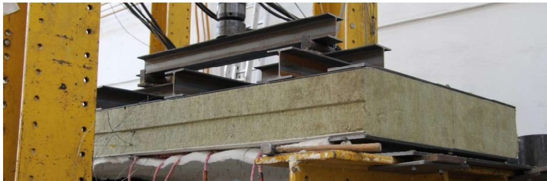
obr. 64: Zkušební sestava před začátkem testu panelu SPA 230E při 600 °C
