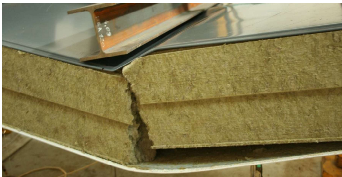
obr. 63: Detail trhliny po testu panelu SPA 230E při běžné teplotě
