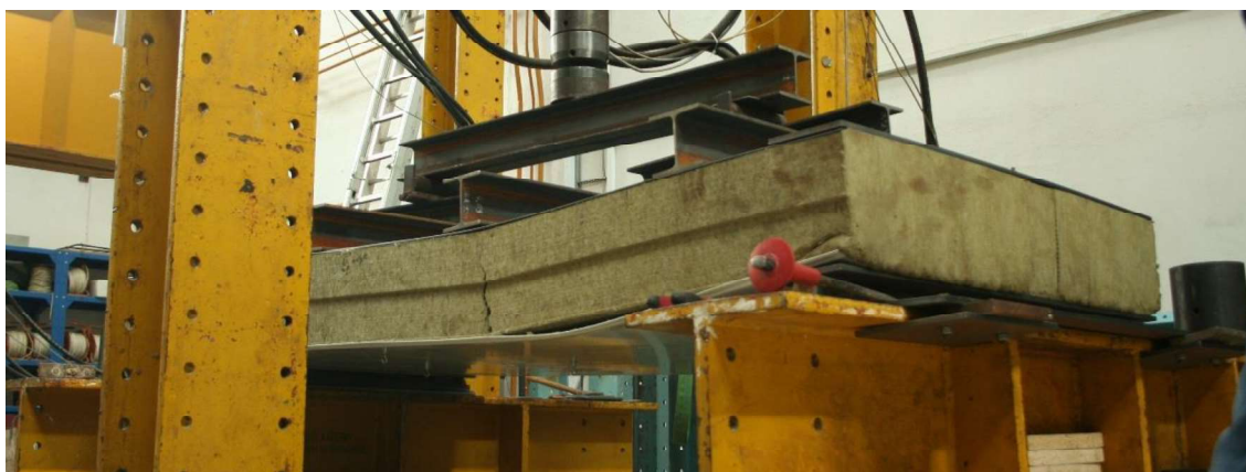
obr. 60: Vzorek během experimentu SPA 230E při běžné teplotě - viditelná deformace
