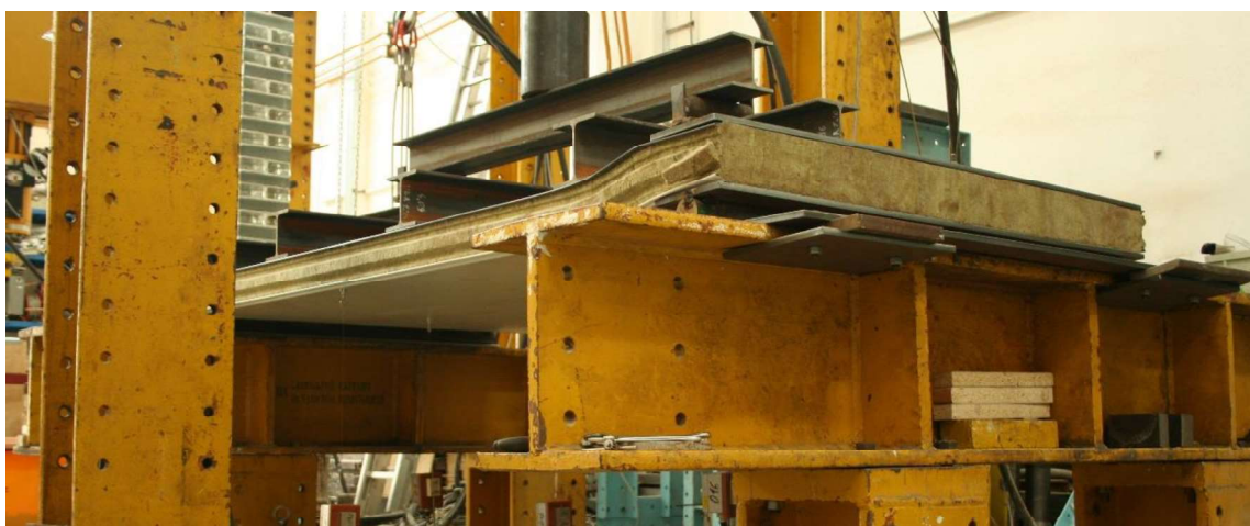
obr. 41: Vzorek během experimentu SPA 100E při běžné teplotě - viditelná deformace
