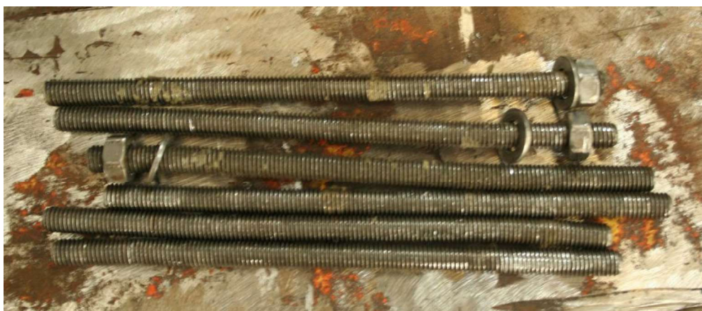
obr. 82: Deformované závitové tyče po experimentu
