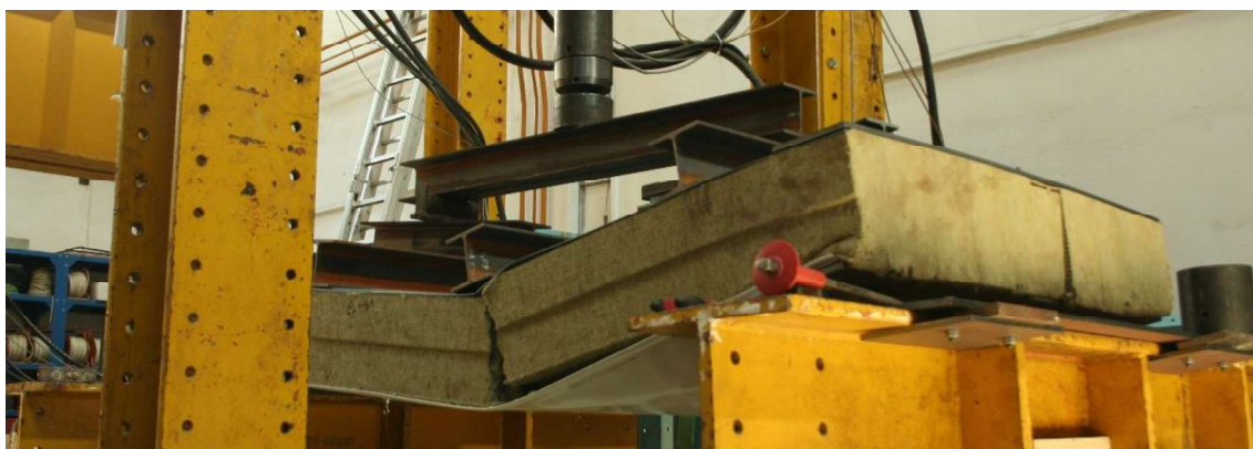
obr. 61: Vzorek během experimentu SPA 230E při běžné teplotě - zvětšení deformací
