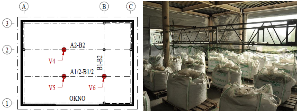
obr. 37 schéma rozmístění deflektometrů
