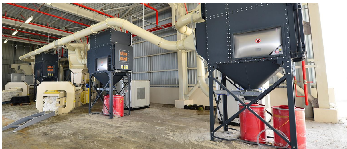
obr. 11: Prachový filtr s membránou pro uvolnění tlaku, vhodné místo pro umístění deflektoru [13]
