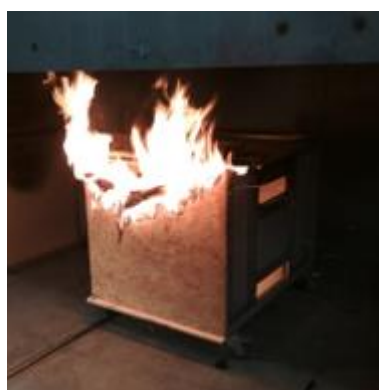
obr. 62 Ukončení požární zkoušky s OSB deskou ve 20. minutě
