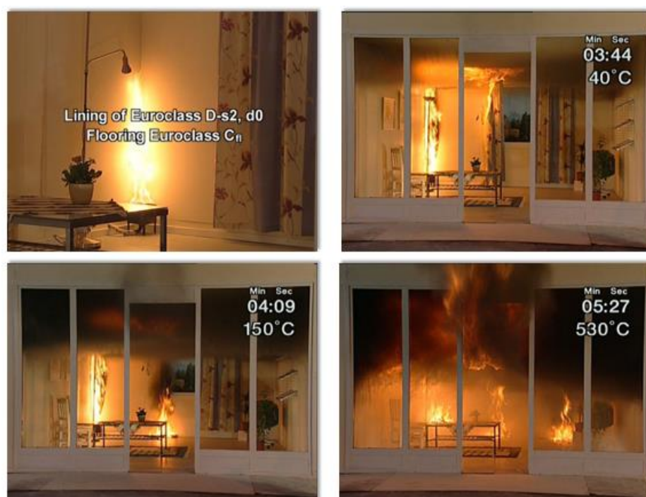
obr. 6 Požární experiment v rohu místnosti – obklad stěn D – s2, d0, podlaha C fl [9]
