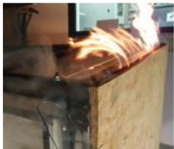
obr. 61 Prohnutí OSB desky a následné zakrytí v průběhu požární zkoušky
