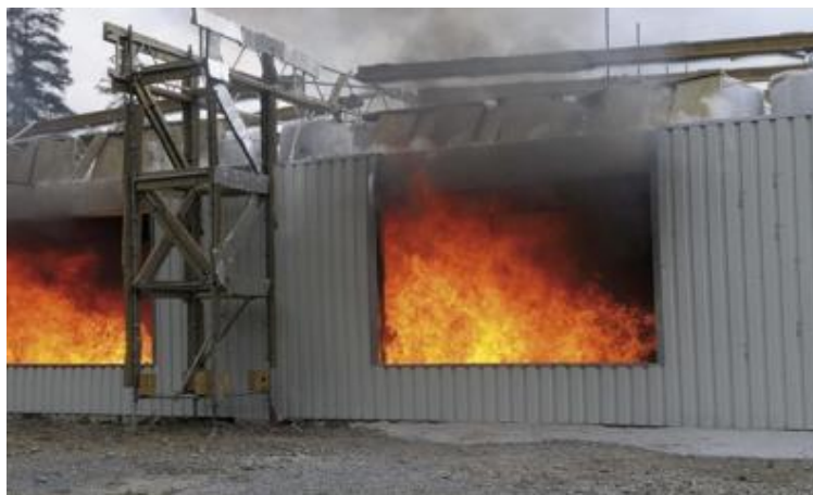
obr. 7 Požární zkouška v Mokrsku [14]
