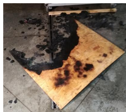
obr. 62 Ukončení požární zkoušky s OSB deskou ve 20. minutě
