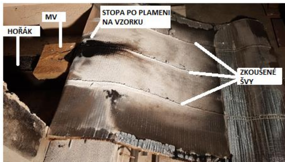
obr. 19 Vzorek textilní rolety po zkoušce, zdroj: AVAPS, s.r.o.
