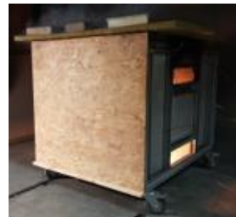
obr. 61 Prohnutí OSB desky a následné zakrytí v průběhu požární zkoušky
