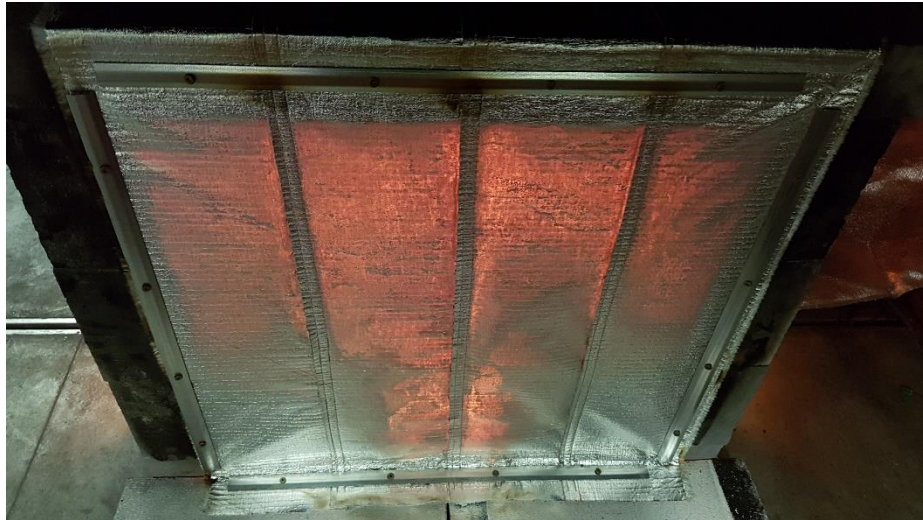
obr. 18 Průběh zkoušky vzorku textilní rolety, zdroj: AVAPS, s.r.o.
