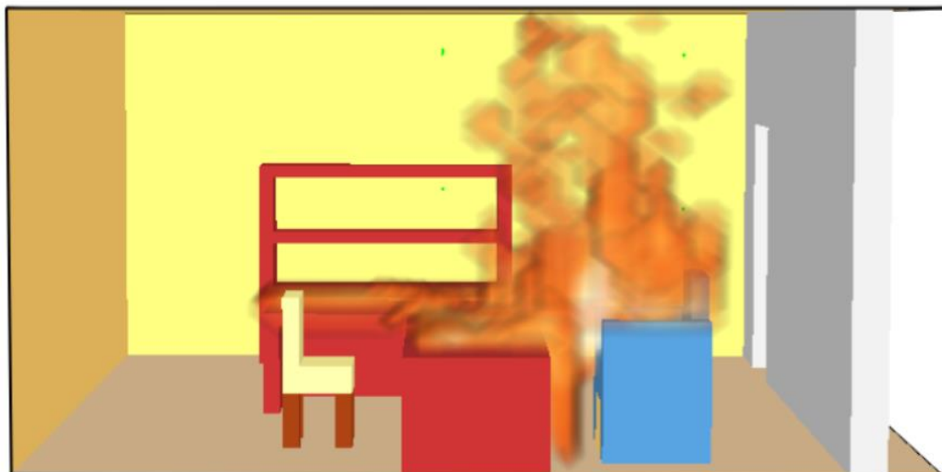
Obr. 29 Plně rozvinutý požár v čase 00:02:00
