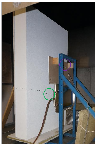
obr. 15 - Umístění povrchového termočlánku a radiometru
