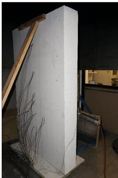
obr. 14 - Umístění plášťových termočlánků
