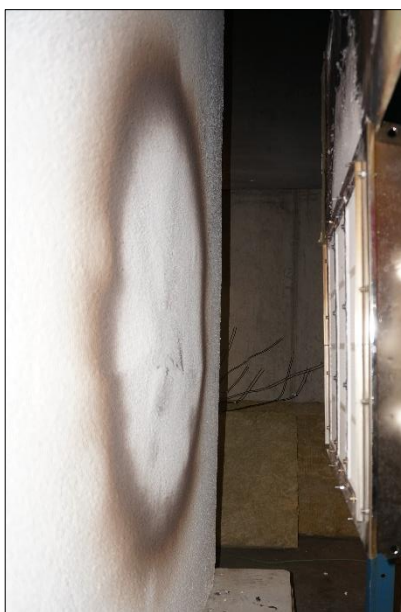
obr. 67 - Vzorek E2, po ukončení zahřívání
