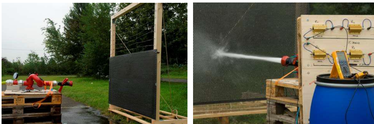
Obr. 16 Experiment se simulovaným tělesným odporem pro měření svodových proudů [13]
