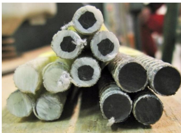
obr. 3 Detail kompozitní výztuže [5]
