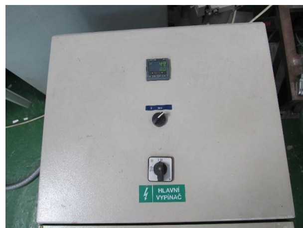
obr. 33 Pícka s topnými spirálami a ovládací panel s termostatem
