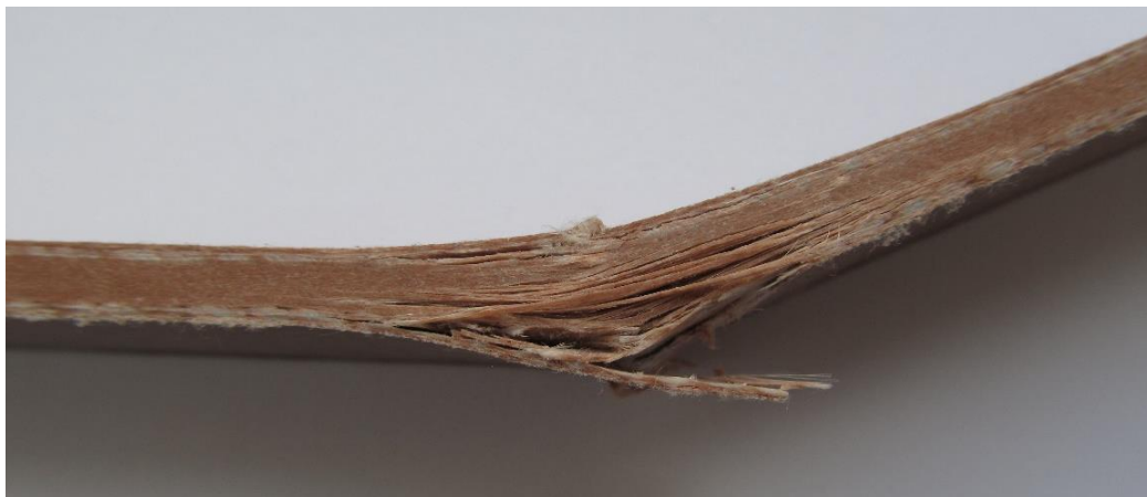
obr. 39 Tahové porušení vzorku č. 3
