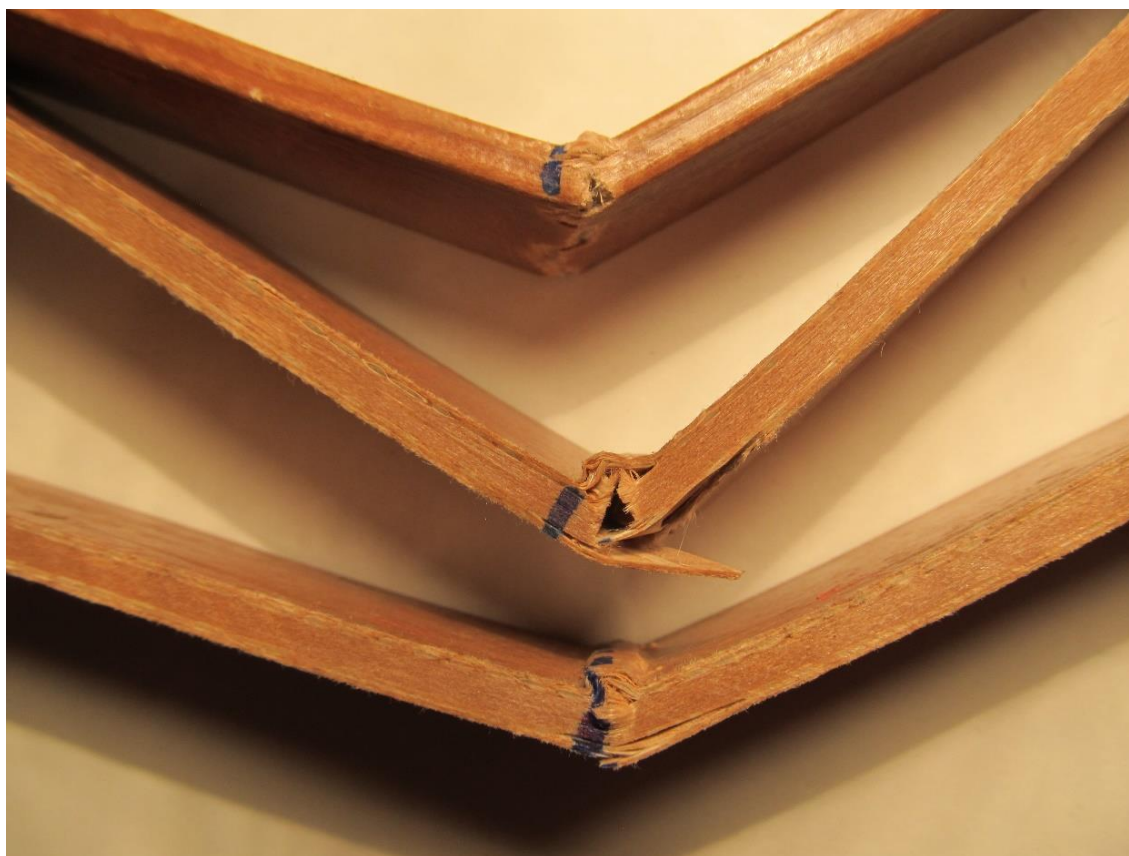
obr. 38 Tahové porušení vzorků č. 4, 7 a 10
