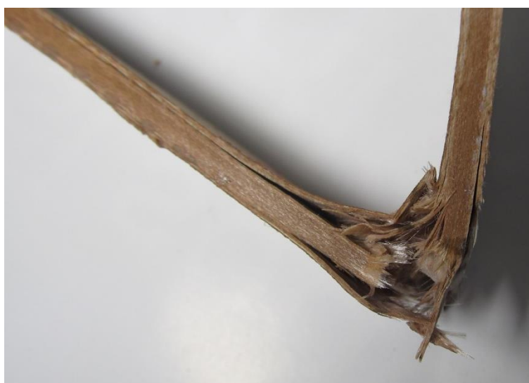
obr. 41 Tahové porušení krajové vrstvy vzorku č. 16
