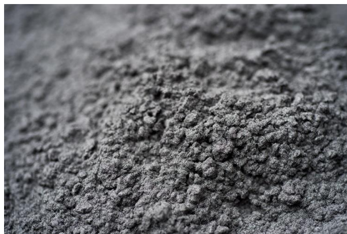
obr. 29 Mletá směs uhlíkových vláken určená pro recyklaci [33]
