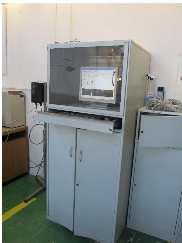
obr. 34 Výpočetní stanice pro kontrolu zařízení a záznam průběhu zkoušky
