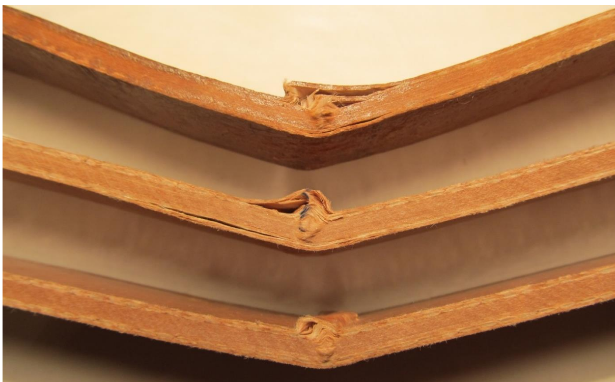
obr. 43 Tlakové porušení vzorků č. 9, 12 a 15
