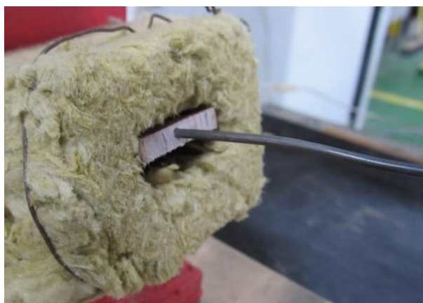
obr. 37 Termočlánek umístěný v kompozitu
