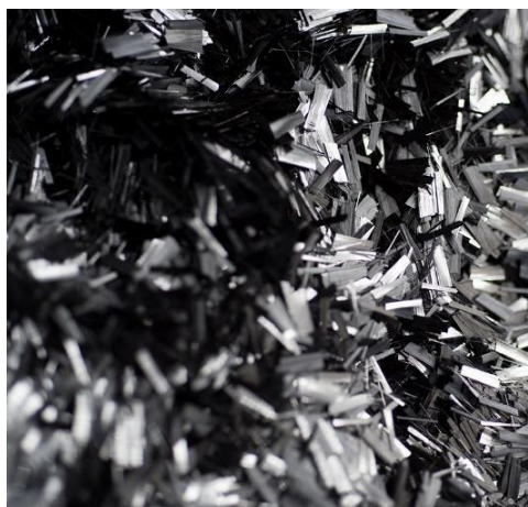
obr. 28 Směs uhlíkových vláken o velikosti 6 až 12 mm [32]
