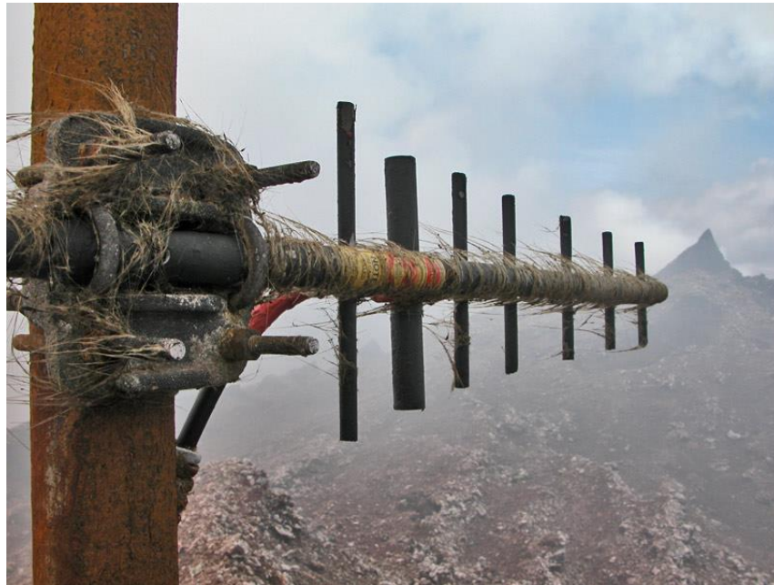
obr. 13 Příklad přírodních čedičových vláken zachycených na anténě [15]
