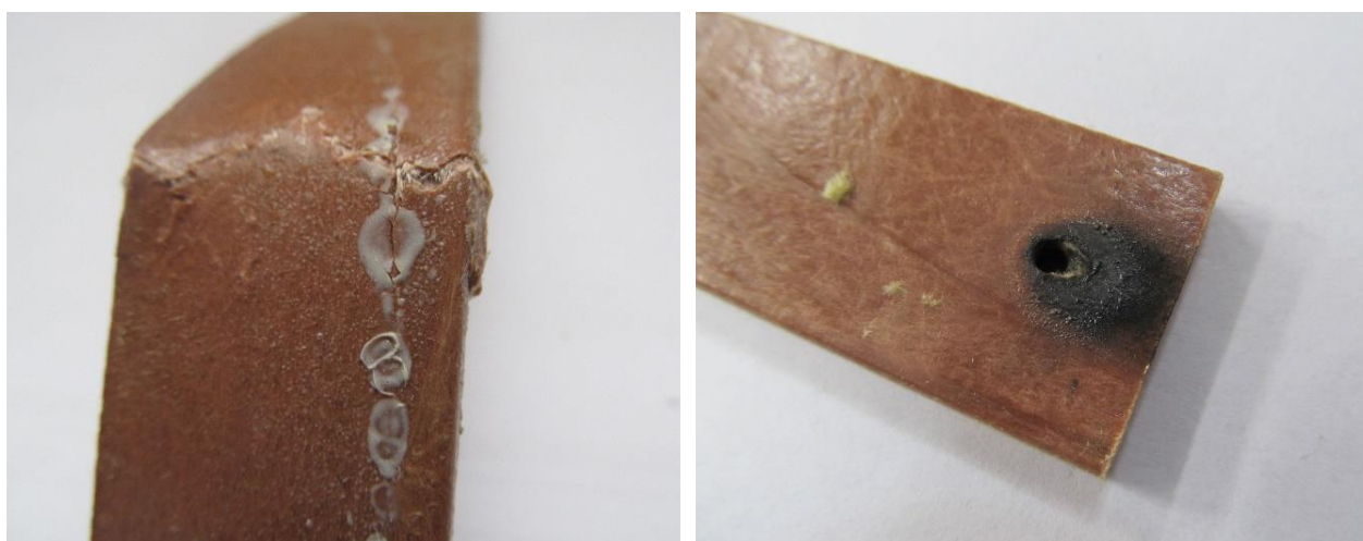
a) Pojivo uvolněné ze zkušebního tělesa během ohybové zkoušky vlivem zvýšené teploty
