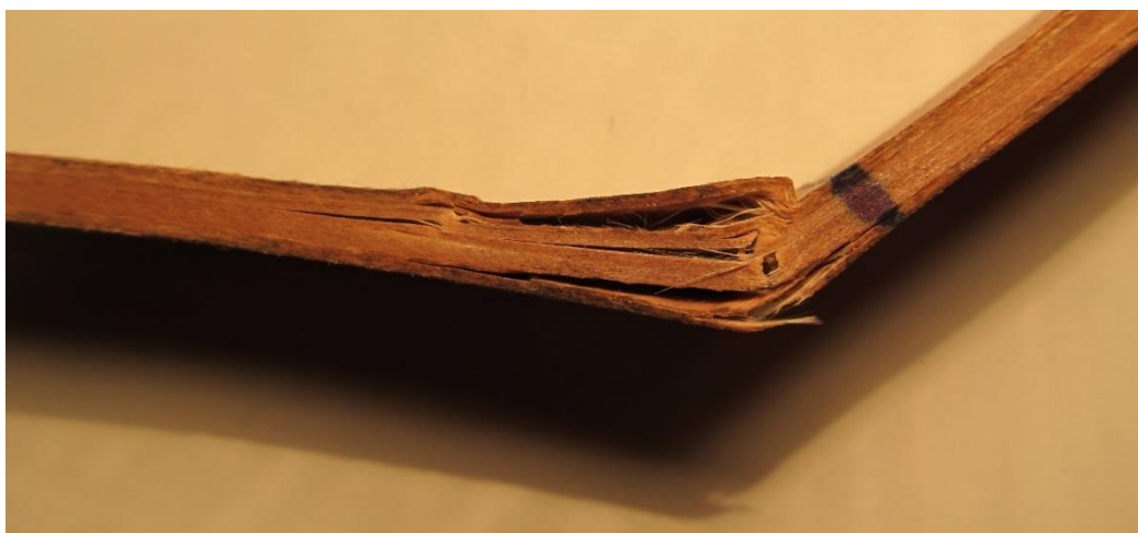
obr. 40 Tahové porušení krajové vrstvy vzorku č. 11
