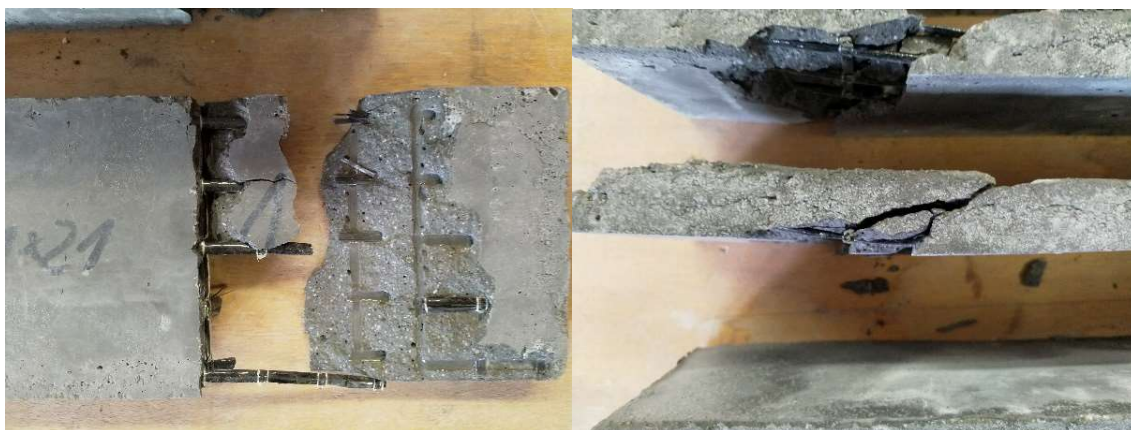
Obr. 36: Smykové porušení vzorků
