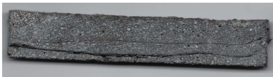
Obr. 60: Vzorek vyztužený tkaninou
