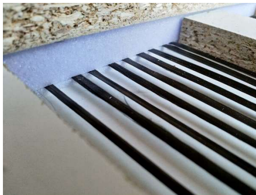
Obr. 32: Napnutí vláken v distanci od spodního povrchu 2 mm
