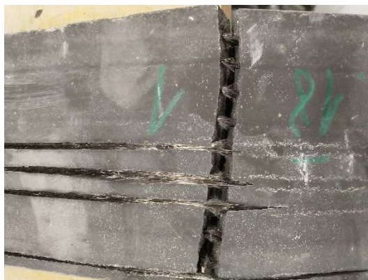
Obr. 48: Vzorek po zkoušce – neporušená vlákna, jen vytažena
