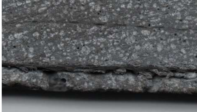
Obr. 61: Detail vzorku s tkaninou – nespolutůsobení tkaniny s betonem
