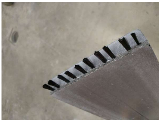
Obr. 45: Vyztužený vzorek, krycí vrstva 2 mm
