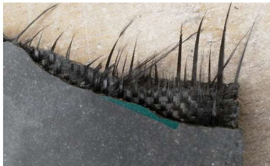
Obr. 44: Úlomek po zkoušce – nepropojení betonu a tkaniny
