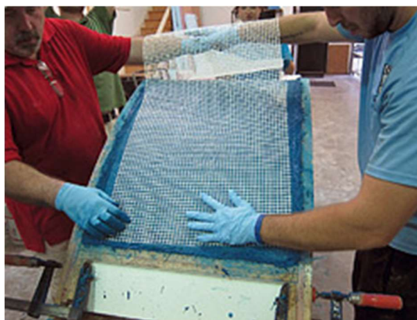
Obr. 14: Kladení textilie, převzato z [http://www.concretedecor.net/decorativeconcretearticles/vol-13-no-7-october-2013/casting-thin-concrete-furniture-with-gfrc/#prettyPhoto] [19]
