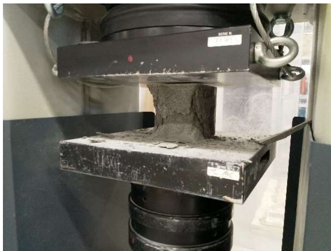
Obr. 54: Tlakové porušení krychle
