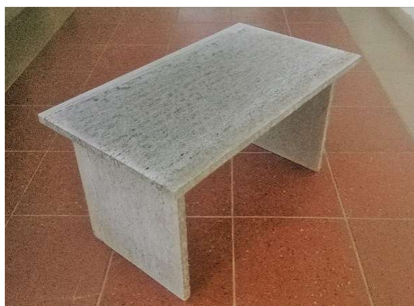
Obr. 15: Lehčený beton s 3D výztuží, převzato z [F. VASTL, BAKALÁŘSKÁ PRÁCE - Návrh konferenčního stolku z lehkého betonu vyztuženého sítěmi] [8]
