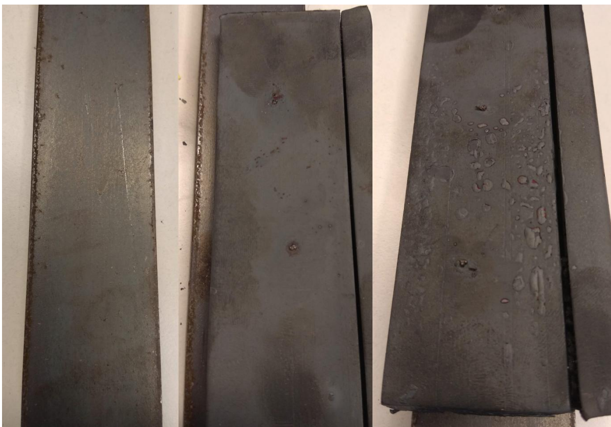
Obrázek 23: Materiál před zahřátím, rovnoměrné okujení, odlupující se okuje
