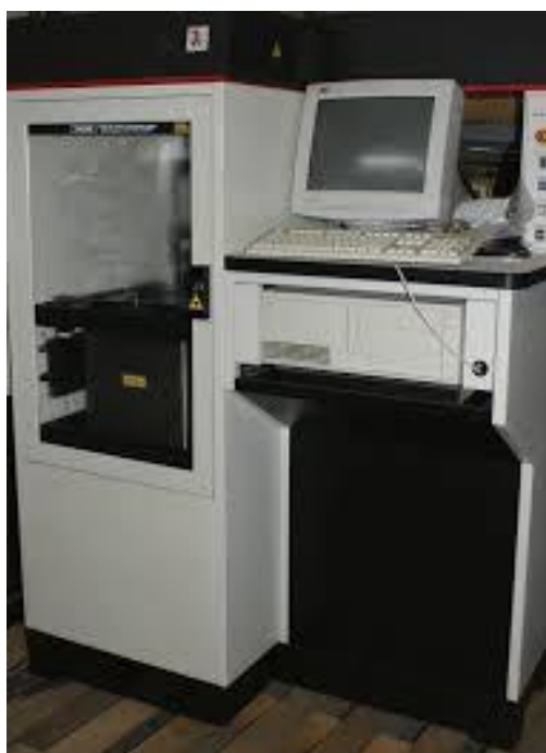
Obr. 1: První verze tiskárny SLA 250 [27]
