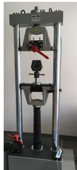
Obr. 13: Zkušební stroj pro tahovou zkoušku W+B ZD10/90, Autor obrázku: Vích Ondřej
