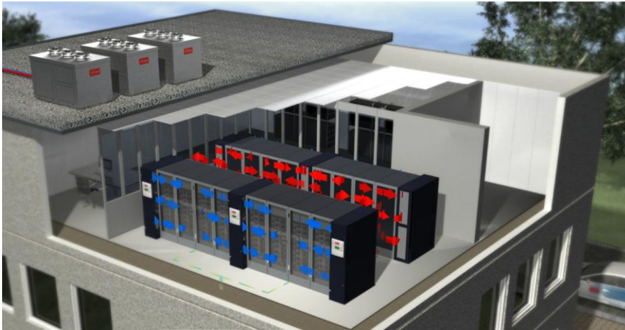
Obr.40 CW – Režim chlazené vody
