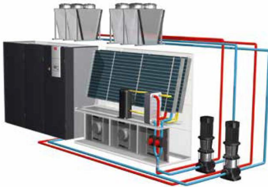
Obr.11 GE Systém (Glycol, Indirect Free Cool) Hybridní G Systém s nepřímým volným chlazením
