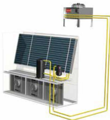
Obr.9 A Systém Kompresorové chlazení
