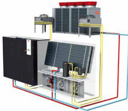
Obr.14 ACW Systém CW Systém s redundatním A systémem
