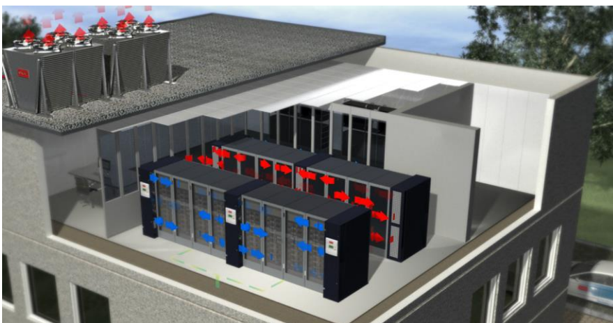
Obr.41 GE – Nepřímé volné chlazení s nemrznoucí kapalinou
