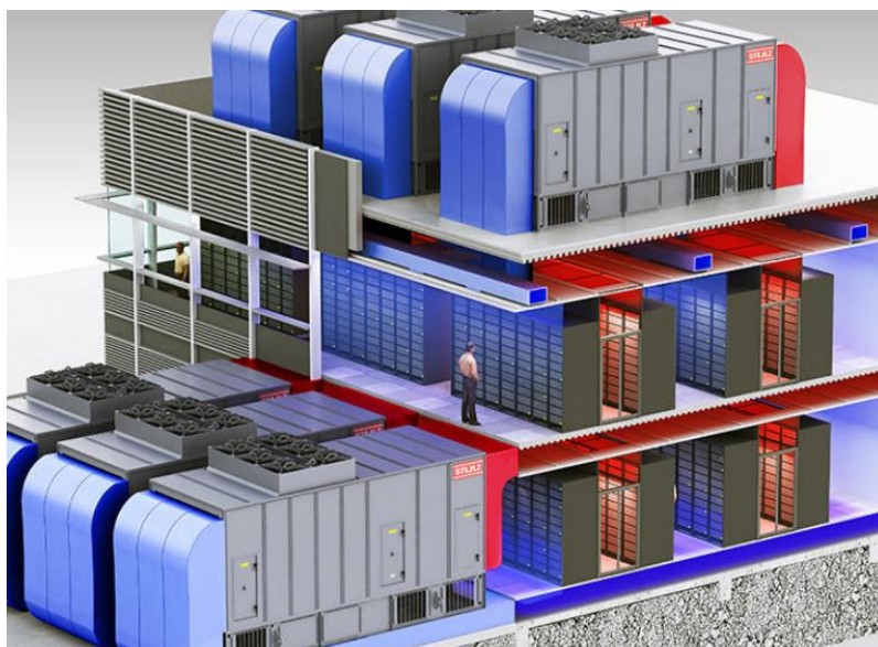
Obr.32 Příklad instalace adiabatického systému chlazení datových center [15]
