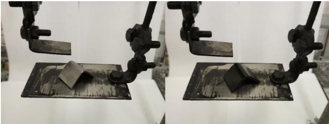
Obrázek 7a,b: Ukázka depozice (položení) vzorku na katodu opatřenou hydrofobním postříkem před ponořením do KTL lázně vlevo, vpravo vyjmutí elektrod z KTL lázně a oplach ultrafiltrátem, drobný díl vykazuje 100 % povlakování.
