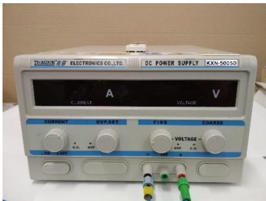
Obrázek 8: Zdroj stejnosměrného elektrického proudu THAOXIN KXN-5005D (5 A, 500 V).
