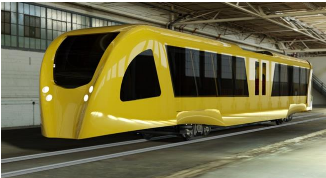
Obrázek 4: Koncept nízkopodlažního kolejového autobusu [6]
