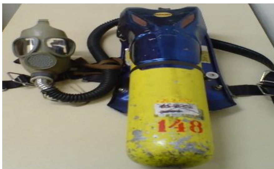
Obr. 3 – Dýchací přístroj Saturn k ochraně před fosgenem [21]
