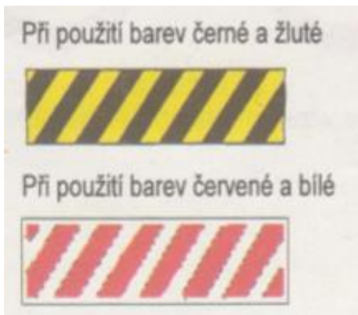
Obr. 6 - Barevné provedení značky označující riziko střetu osob s překážkami nebo pádu osob
