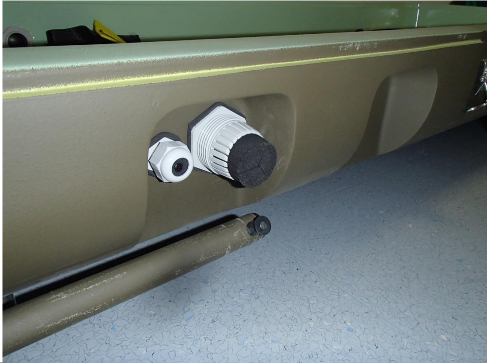
Příloha 11 Ukázka modernizace prostupů na kabely (zdroj: vlastní, výcvik BHT ZZS v OBO Těchonín)
