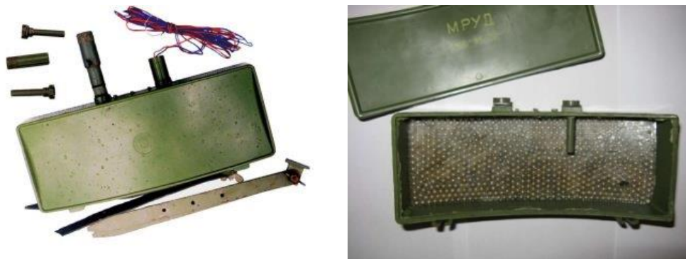
Obrázek 13 Protipěchotní mina MRUD včetně pohledu na uložení ocelových kuliček [35]
