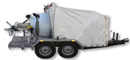
Obrázek 6 Výbuchová komora NABCO [vlastní]
