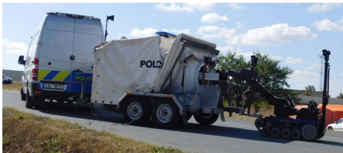
Obrázek 6 Výbuchová komora NABCO [vlastní]
