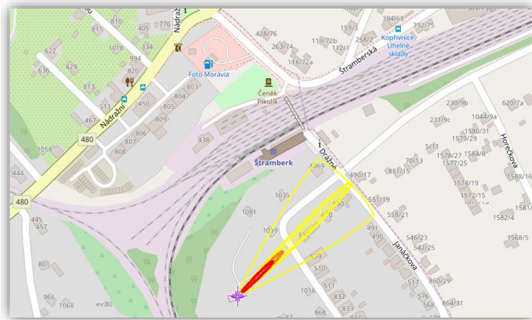
Obrázek 25 Grafické znázornění vypočtených parametrů rozptylu zemního plynu při erupci sondy 2 7/8" bez PPBV
