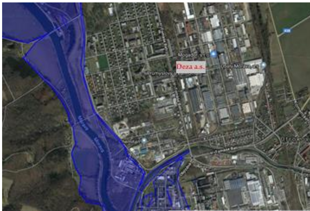
Obrázek 11 Simulace POSIM - Q100 na řece Moravě (Otrokovice)
