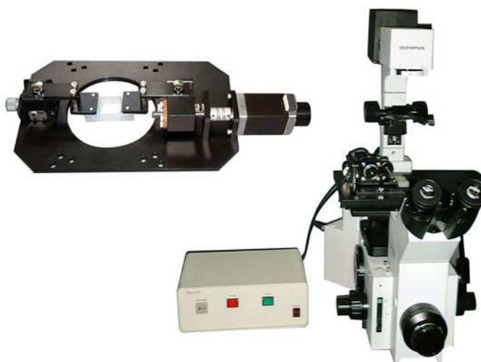
Obrázek 1.2: Strex zařízení připevnitelné na mikroskop. Převzato z [32].
