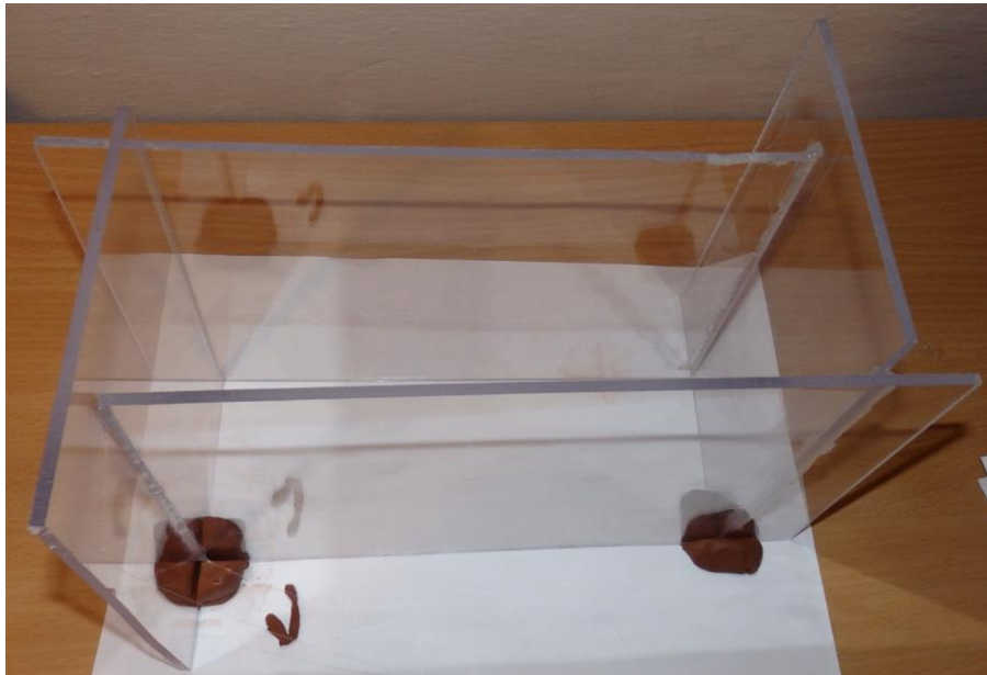
Obrázek 5.13: Provizorní fixace stěn bednění pomocí modelovací hmoty
