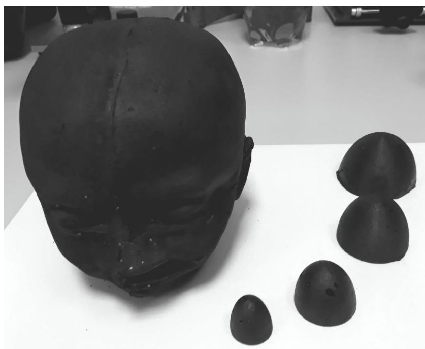
Obrázek 6.18: Vytvořený fantom hlavy novorozence a série fantomů ischemické CMP
