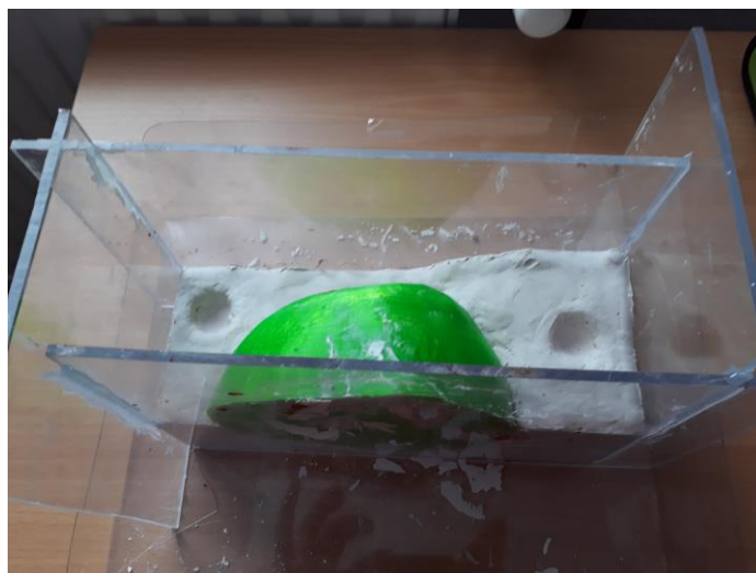
Obrázek 5.19: Připravené bednění na odlití druhého dílu formy
