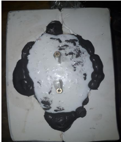
Obrázek 5.26: Vlevo vytlačené přebytky z formy, vpravo hotová vrstva mozkomíšního moku
