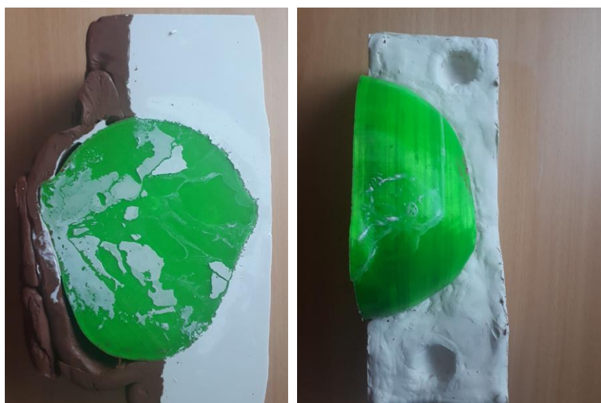
Obrázek 5.18: Sejmuté bednění (vlevo) a sejmutá modelovací hmota (vpravo) z prvního dílu formy
