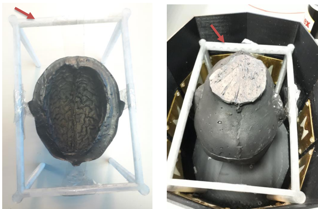
Obrázek 6.20: Navržený držák fantomu (červené šipka) hlavy novorozence, který je kompatibilní s měřícím systémem
