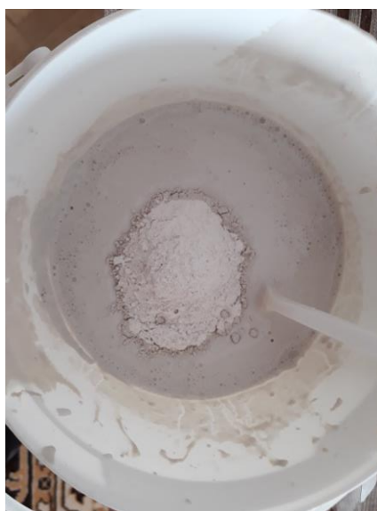
Obrázek 5.16: Příprava sádry na odlévání formy
