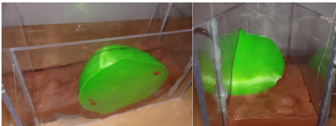
Obrázek 5.15: Umístění modelu v lůžku a bednění
