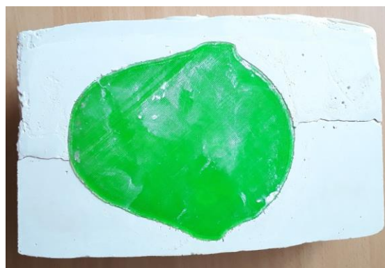
Obrázek 5.20: Hotová dvoudílná forma pro fantom kůže
