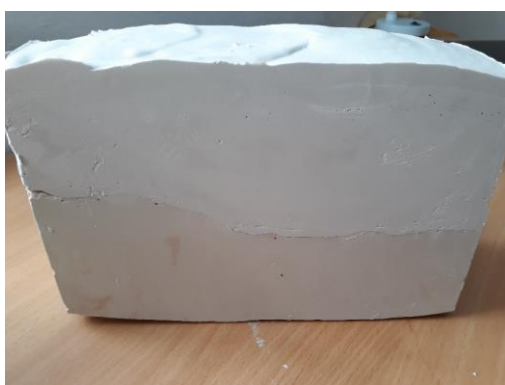
Obrázek 5.20: Hotová dvoudílná forma pro fantom kůže
