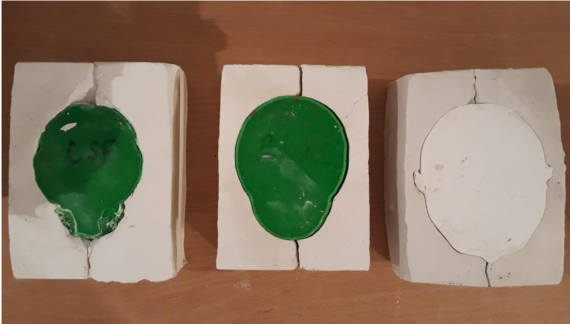
Obrázek 6.16: Vytvořené sádrové formy pro horní polovinu hlavy novorozence
