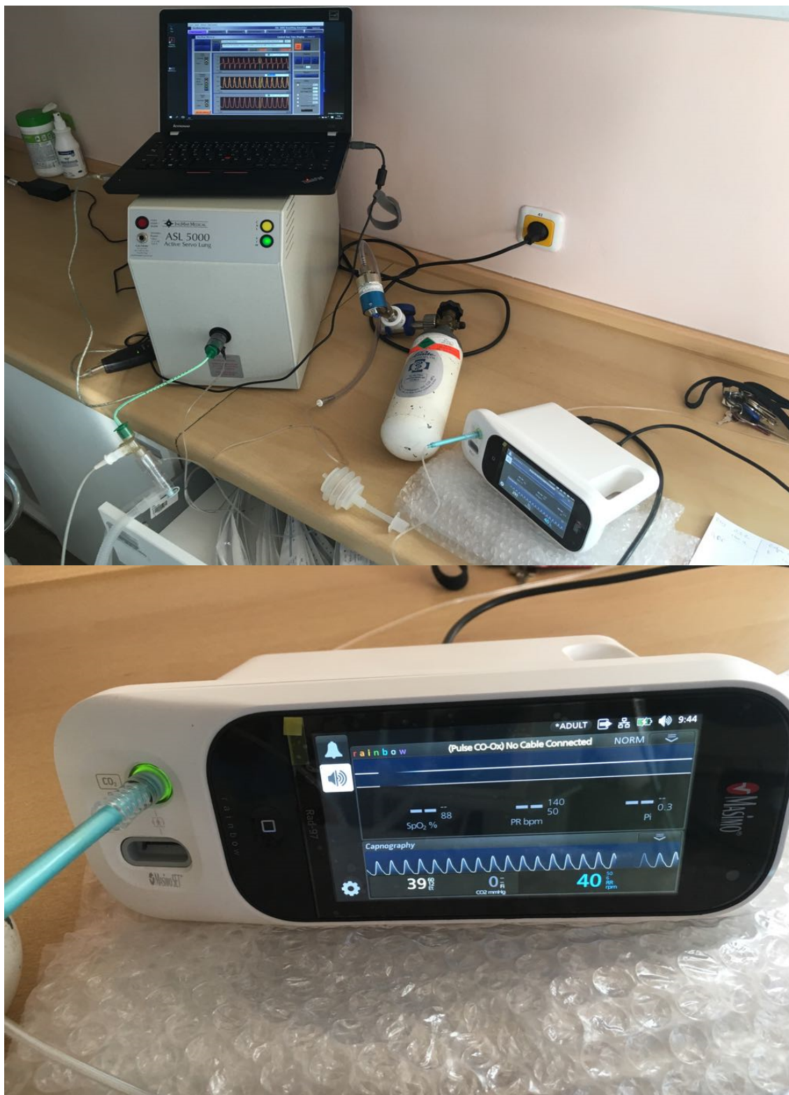
Obr. A.1: Ukázka experimentálního okruhu využitého při praktickém měření a detailní pohled na pacientský monitor Rad-97. Fotodokumentace autora
