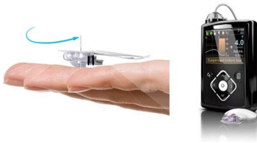
Obrázek 1.4: Senzore Enlite (vlevo) a transmitter s vysílačem. [48].
