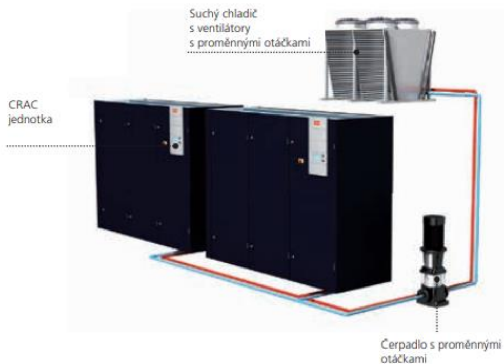
Obrázek 7 Schéma systému nepřímého volného chlazení [9]
