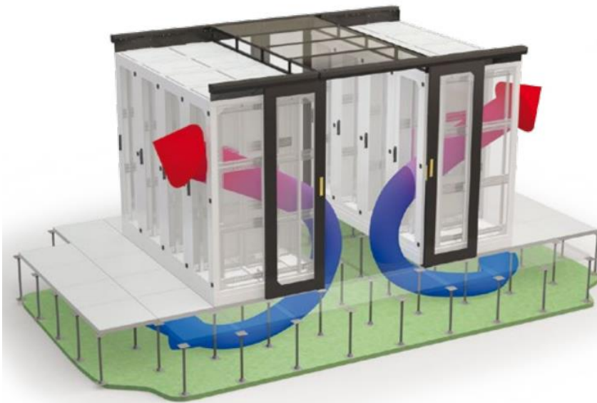
Obrázek 2 Schéma uzavřené studené uličky pro chlazení DC [6]
