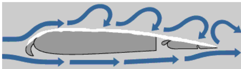
Obrázek 4 Proudění vzduchu na namrzlém křídle
