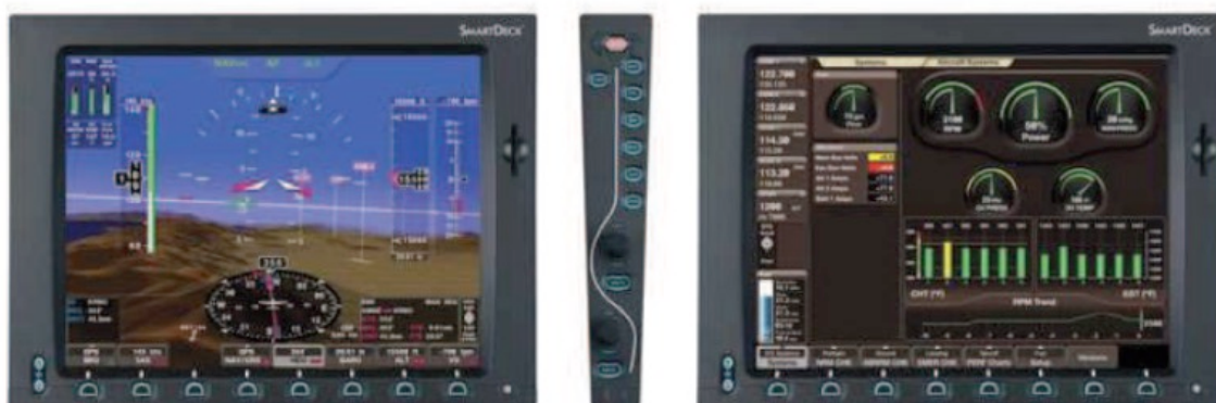
Obrázek 15 - Displeje a ovládač displejů výrobku SmartDeck 25
