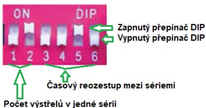
Obrázek 4.6.4.1 – 2 – ZON EL08 Blok se 6 DIP přepínači (návod k použití Oslavan, a. s.)
