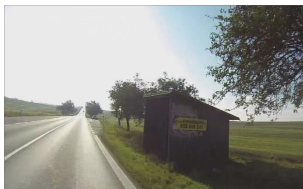
Obrázek 16: Absence nebo opotřebované VDZ, neadekvátní podmínky pro pěší: krátká / neadekvátně provedená nástupní hrana a absence návaznosti na pěší infrastrukturu (staničení 143,596 km)
