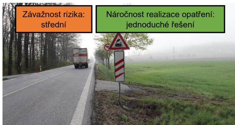
Obrázek 73: Neadekvátně provedení SDZ A 30 a A 31a (NL Libějovice)
