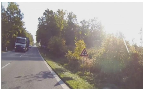
Obrázek 8: Neadekvátní umístění SDZ (staničení 153,365 km)
