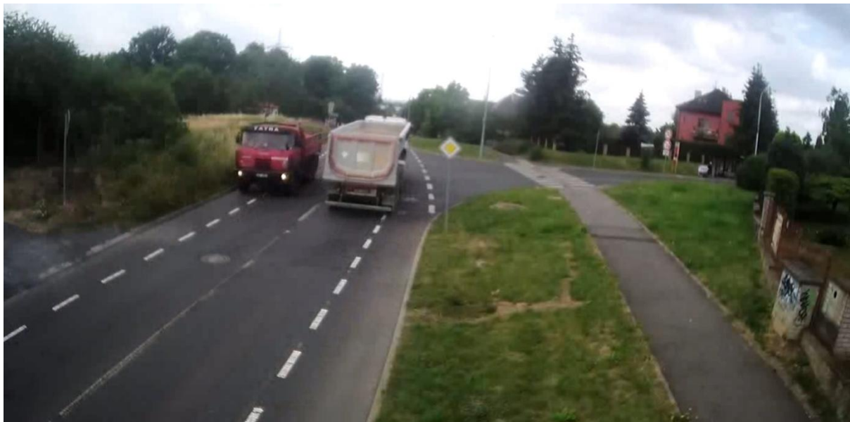
Obrázek 53 – řidič taty jede v ochranném pruhu blízko obruby, zatímco protijedoucí řidič se snaží do ochranného pruhu co nejméně zasáhnout
