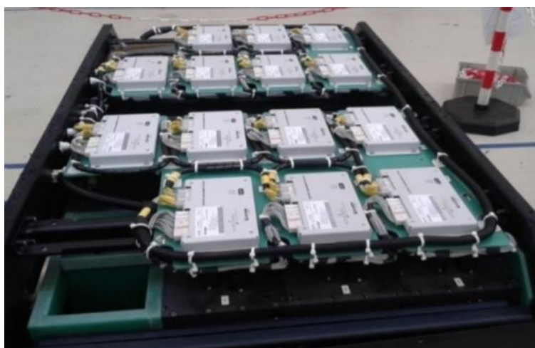
Obrázek 14: Box s trakčními bateriemi u vozidla Škoda 26 Tr (zdroj: Hurtová a Sejkorová, 2016)
