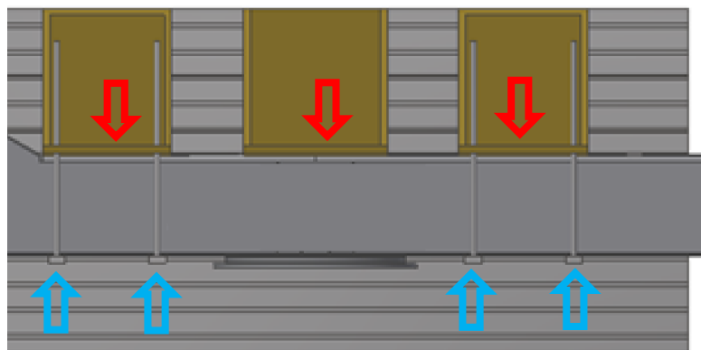
Obrázek 38 Znárodnění směru síly působící hydraulickým mechanismem (červeně) a směry upnutí (modře) v druhé koncepci
