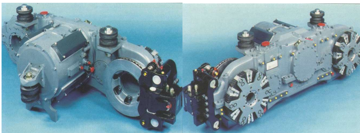
Obrázek 4 - Pohonný blok vozu Urbos 3 [2]
