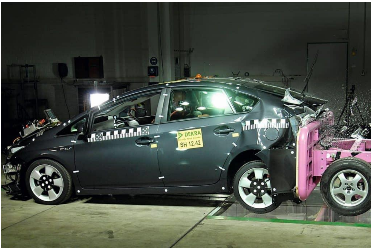
Obrázek 6: Zkouška na simulátoru nárazu DEKRA [9]
