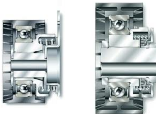
Obr. 27.: Automatické napínací systémy s jedním excentrem (vlevo) a se dvěma excentry (vpravo) [17]
