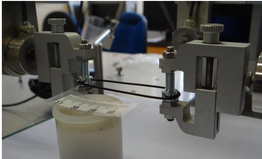
Obrázek 14: Referenční konfigurace měření O-kroužku
