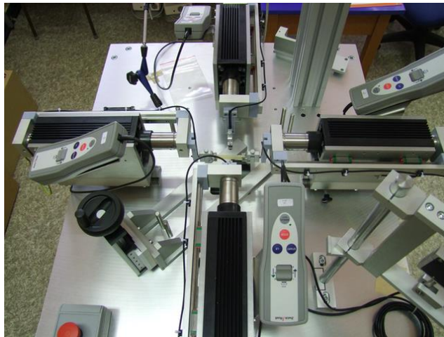
Obrázek 13: Biaxiální zatěžovací stroj [17]
