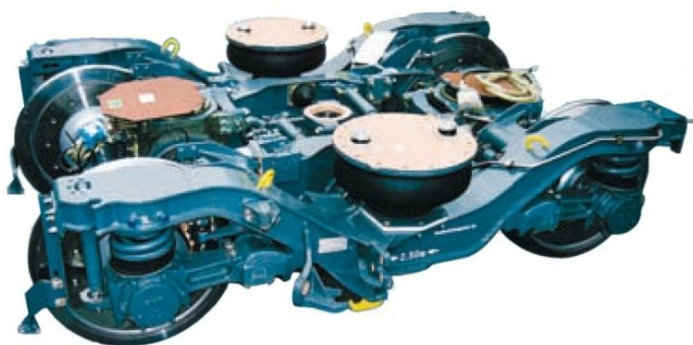
obr. 8.: Podvozek Siemens SF 500 [11]
