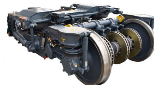
obr. 26.: Netrakční podvozek Bombardier FLEXX Speed
