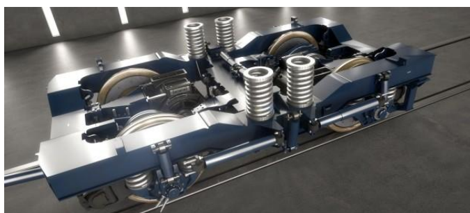
obr. 16.: Podvozek Bombardier Flexx Power [21]
