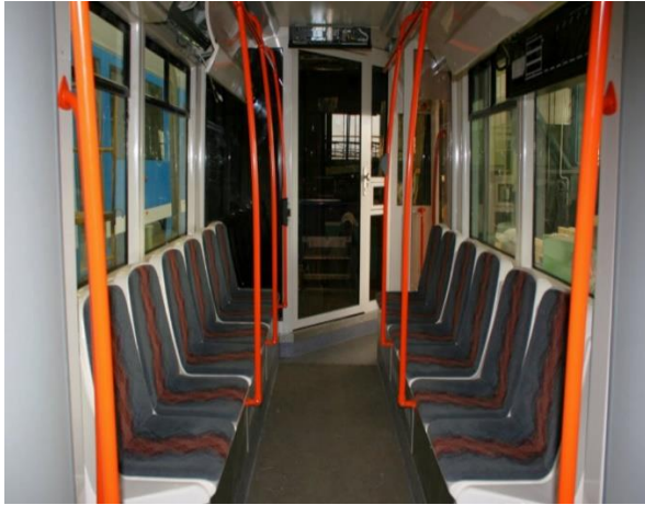
Obrázek 4 - Uspořádání sedadel 1+1 s podélnou zástavbou [6]
