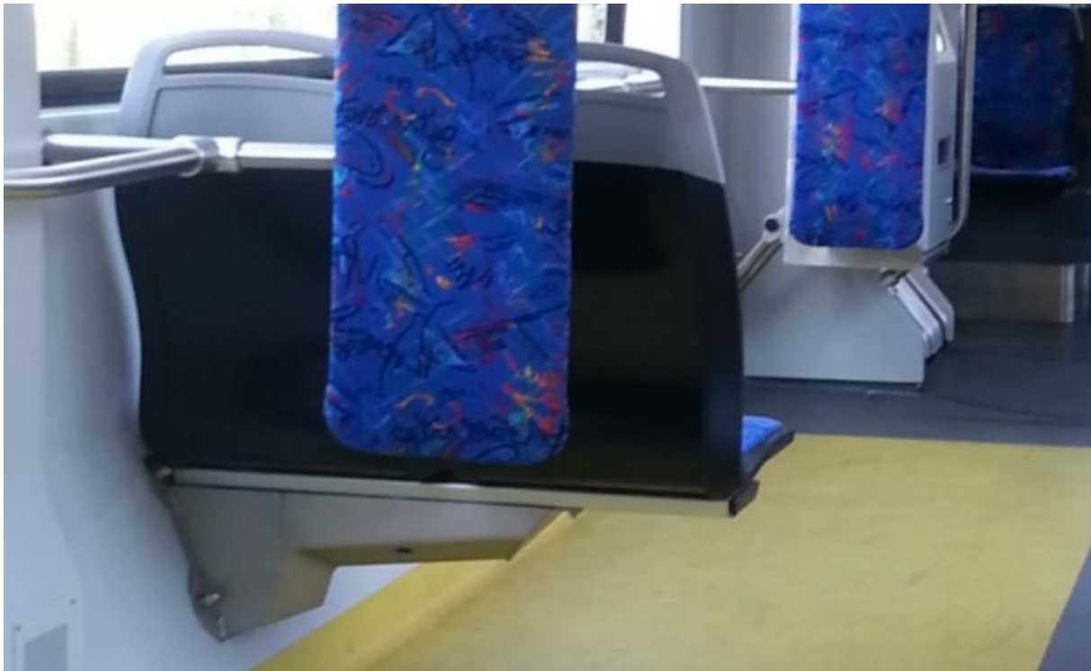
Obrázek 25.1 - Řešení konzole u tramvaje Vossloh Tramlink 6N2 [22]
