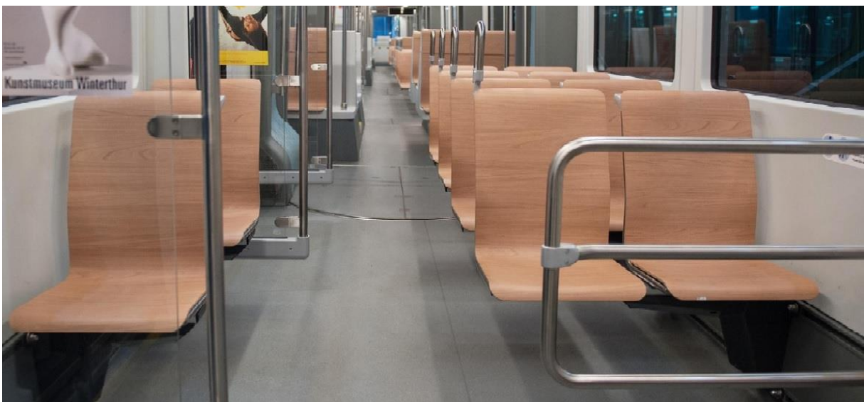
Obrázek 25 - Konzole sedadla u tramvaje Bombardier flexity [21]
