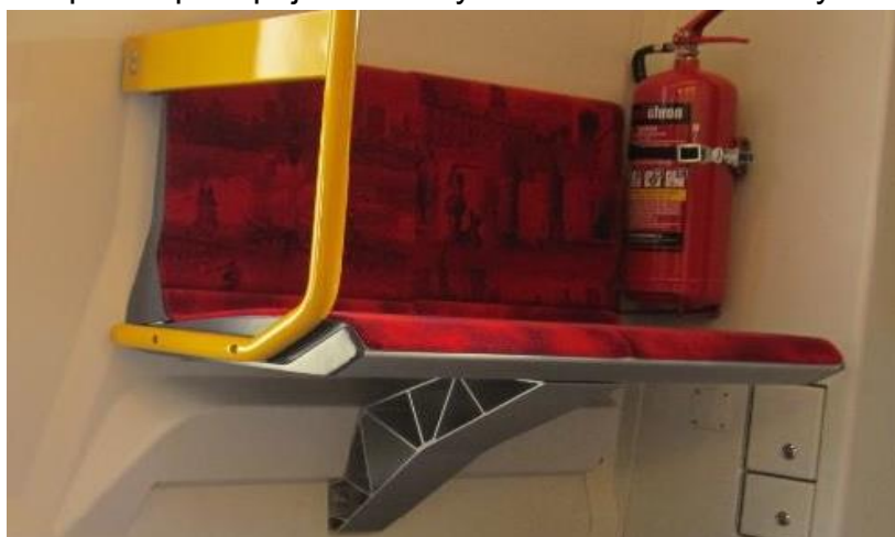
Obrázek 23 - Konzole sedadla z protlačovaného profilu [2]
