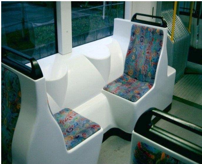
Obrázek 9 - Podesta Siemens Combino [7]
