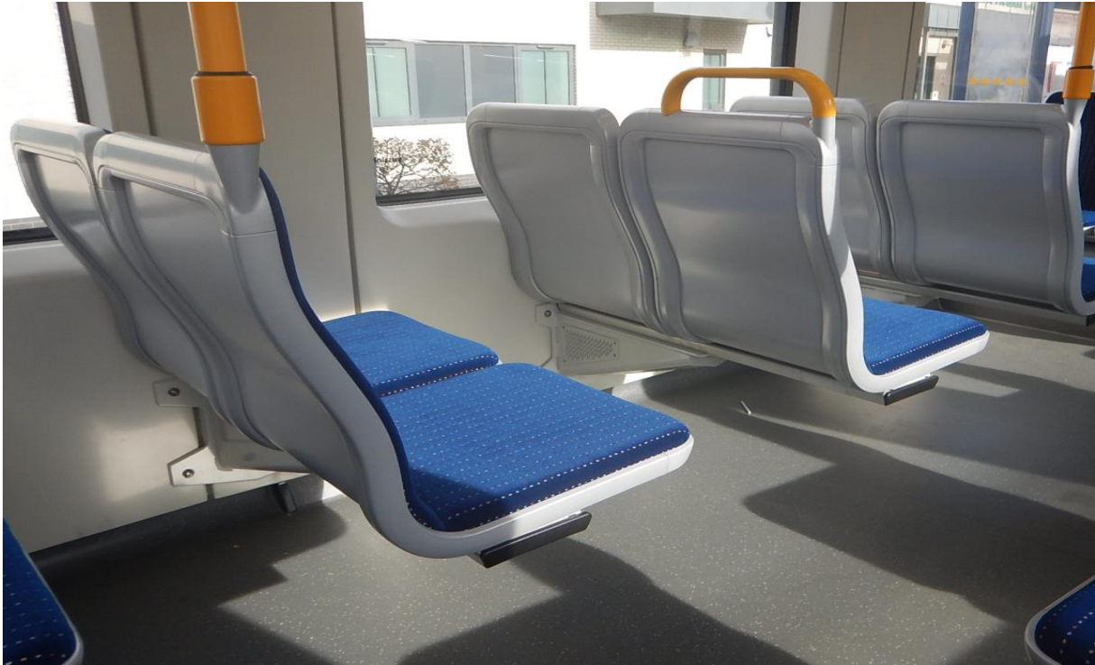
Obrázek 24 - Konzole sedadla u vozidla Vossloh supertram class 399 [20]
