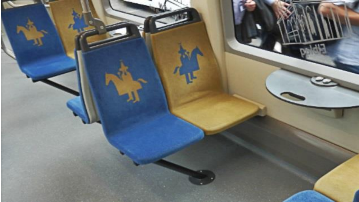
Obrázek 13 - Řešení konzole u tramvaje Pesa Krakowiak [11]
