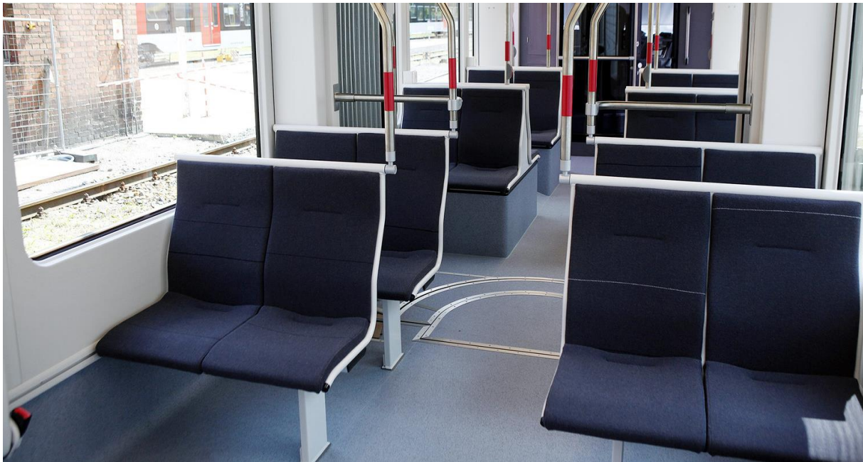
Obrázek 12 - Řešení konzole u tramvaje Stadler Tango [10]
