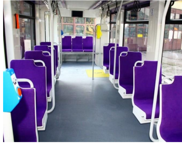
Obrázek 5 - Uspořádání sedadel 1+1 s příčnou zástavbou [3]
