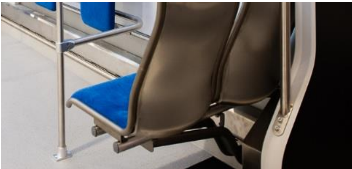
Obrázek 18 - Konzole sedadla od společnosti Solaris Tramino [14]
