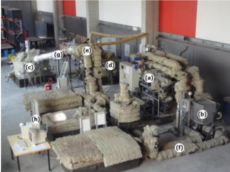
Obr. 9 Experimentální smyčka [9]: (a) elektrický kotol, (b)výměník vzduch-teplonosné médium, (c) horká nádrž roztavené soli, (d) studená nádrž roztavené soli, (e) výměník teplonosné médium-roztavená sůl, (f) smyčka teplonosného média, (g) smyčka roztavené soli, (h) systém vyhodnocení naměřených dat
