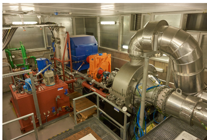
Obrázek 3.2: Experimentální zkušebna s dmychadlem Darina
