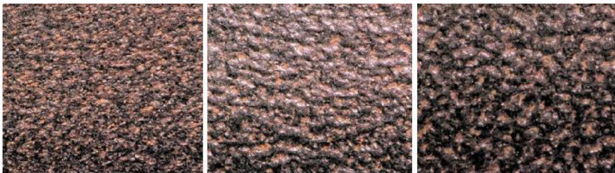
Obrázek 47: Díly ve 1. vrstvě. Čas tryskání 5, 10, 15 sekund (zleva). Zvětšeno 100x.
