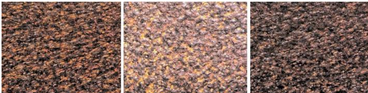
Obrázek 45: Díly v 5. vrstvě. Čas tryskání 5, 10, 15 sekund (zleva). Zvětšeno 100x.
