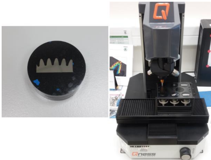
Obrázek 59: Vlevo, vyleštěný vzorek zalitý v pryskyřici. Vpravo, mikrotvrdoměr Qness během měření.
