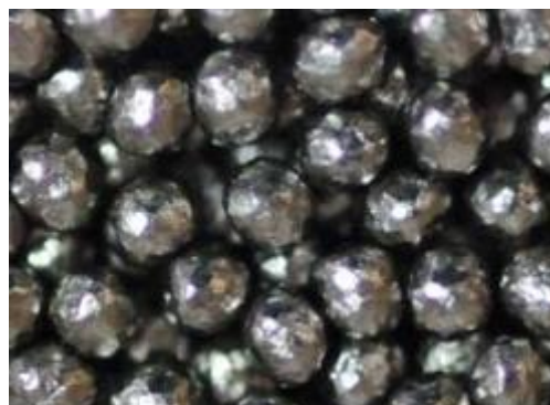
Obrázek 28: Arondovaný ocelový sekací drát, třída G3 [28].
