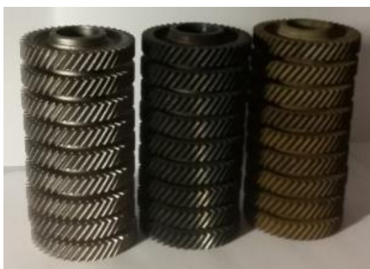
Obrázek 44: Tři sady ozubených kol pro experiment 1.2. Zleva: tryskané, tepelně ovlivněné a chemicky ovlivněné díly.
