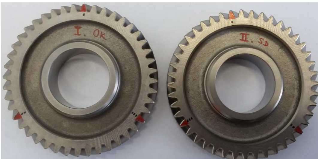
Obrázek 71: Tryskané vzorky připravené na měření drsnosti povrchu. Vlevo: vzorek tryskán ocelovým granulátem. Vpravo: vzorek tryskáný arondovaným sekaným drátem.
