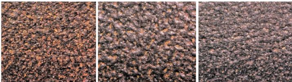
Obrázek 46: Díly ve 3. vrstvě. Čas tryskání 5, 10, 15 sekund (zleva). Zvětšeno 100x.
