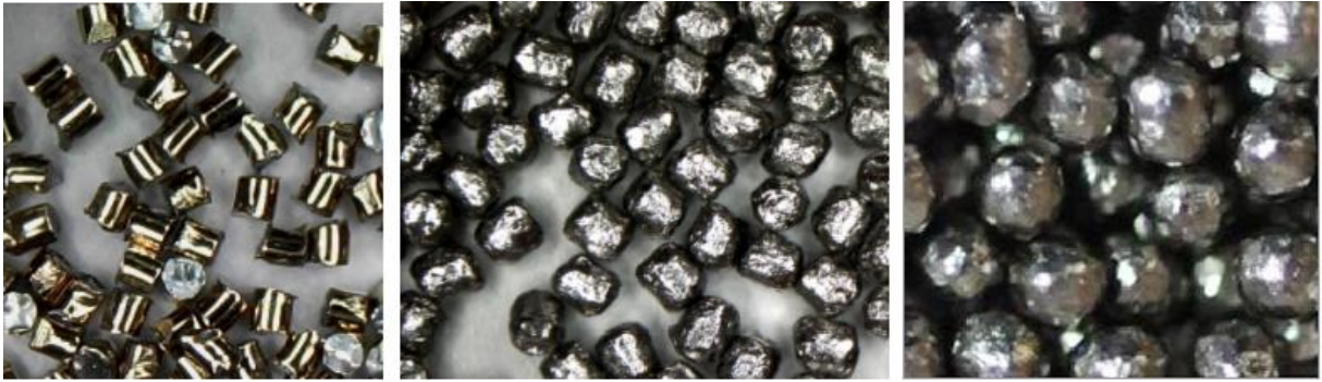
Obrázek 8: Zleva, sekaný drát ve formě ostrohranných pelet (G1), zaoblený sekaný drát (G2), arondovaný sekaný drát (G3).
