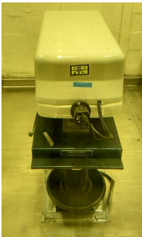
Obr. 34: Čelní pohled na tvrdoměr Indentec ZVH 30 umístěný v polohorké komoře (fotografie pořízena skrze průzor do komory vyrobený z olovnatého skla žluté barvy)
