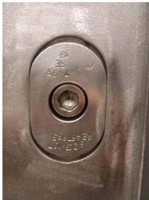
Obr. 16: Detail upevnění hraněného plechu na hraněný pás koše aktivní zóny pomocí šroubu M12 (školicí středisko Paks)
