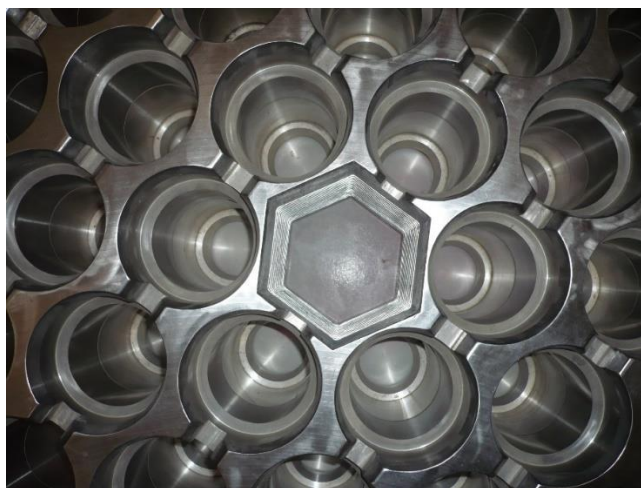
Obr. 14: Detail nosné desky koše aktivní zóny s otvory, uprostřed otvor pro zajištění regulační kazety (školící středisko Paks)
