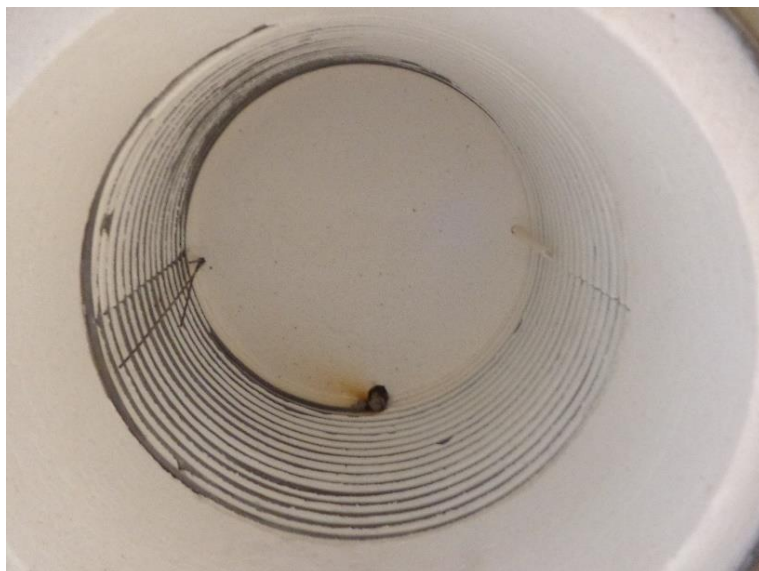
Obr. 31: Pohled do žhací pece, v levé části 3 termočlánky a po obvodu topné elementy. Stěny pece vyrobené z keramického materiálu.
