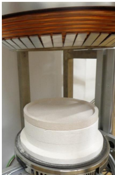
Obr. 30: Otevřená žhací pec (dolní víko), v horní části dobře patrné měděné spirály vodního chlazení.
