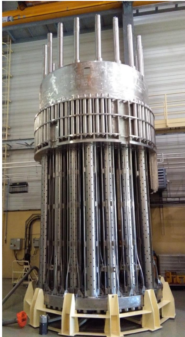
Obr. 18: Blok ochranných trub bez vnějšího pláště (školící středisko Paks)
