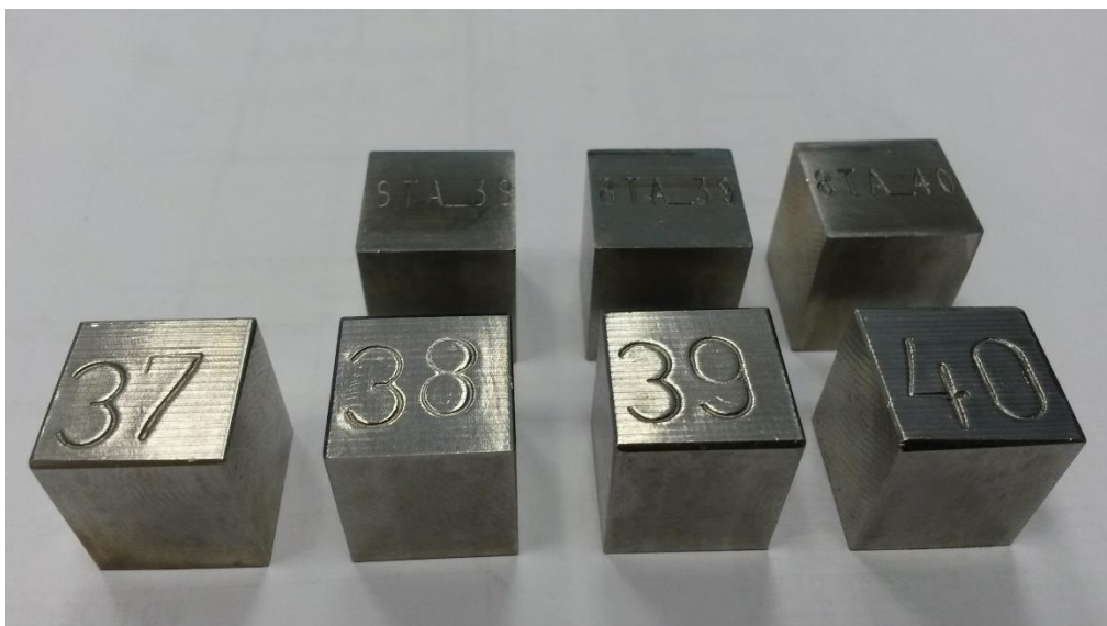
Obr. 43: Zkušební tělesa 15x15x17 mm pro jeden z podobných experimentů; nevyžiháný stav; materiál 08Ch18N10T, odlišná tavba; zdroj = kolektor PG
