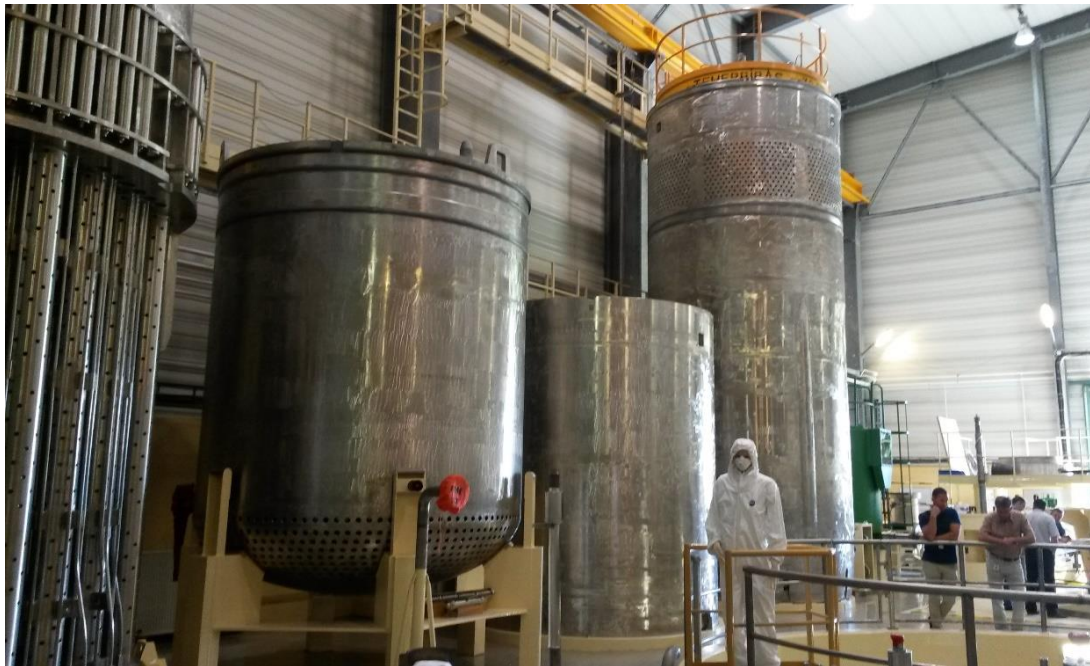
Obr. 3: Vnitřní části reaktoru ve školicím centru Paks v Maďarsku, zleva blok ochranných trub, dno šachty reaktoru, koš AZ a šachta reaktoru (blok ochranných trub je vidět jen částečně)
