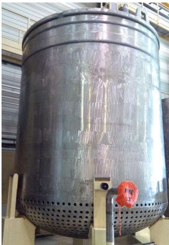
Obr. 9: Fotografie dna šachty reaktoru VVER 440 (školicí středisko Paks)
