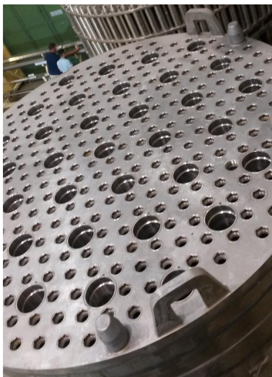
Obr. 10: Pohled na perforovanou horní desku dna šachty reaktoru (školicí středisko Paks)
