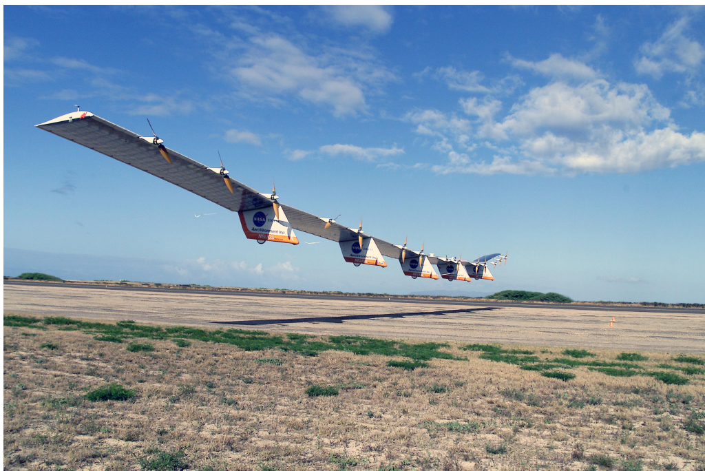
Obr. 12: Experimentálne lietadlo Helios získava el. energiu pomocou fotovoltických článkov na krídle [36].
