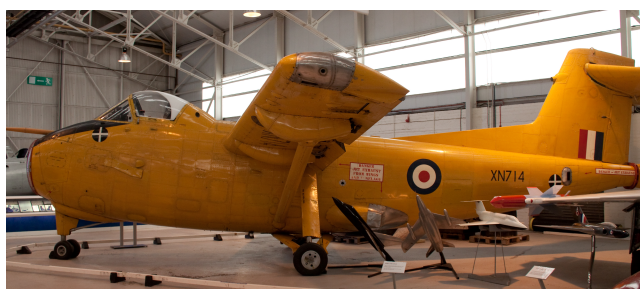
Obr. 4: Letún Hunting H.126, na ktorom bol použitý DPS typu tryskové klapky [19].
