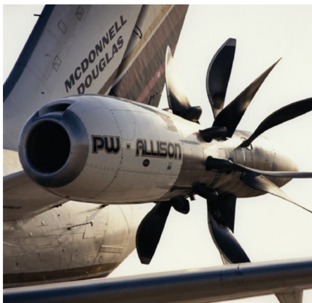
Obr. 19: Pohonná jednotka PW/Allison 578-DX na testovacom lietadle MD-80 [15].
