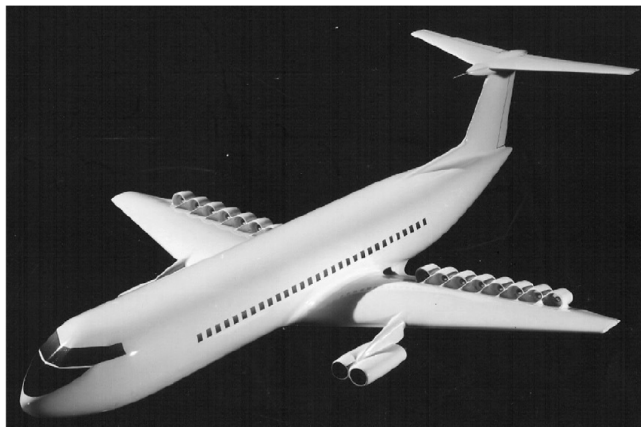
Obr. 7: Aplikácia funkcie krátky vzlet a pristátie na koncepčnom modeli dopravného letúna [19].
