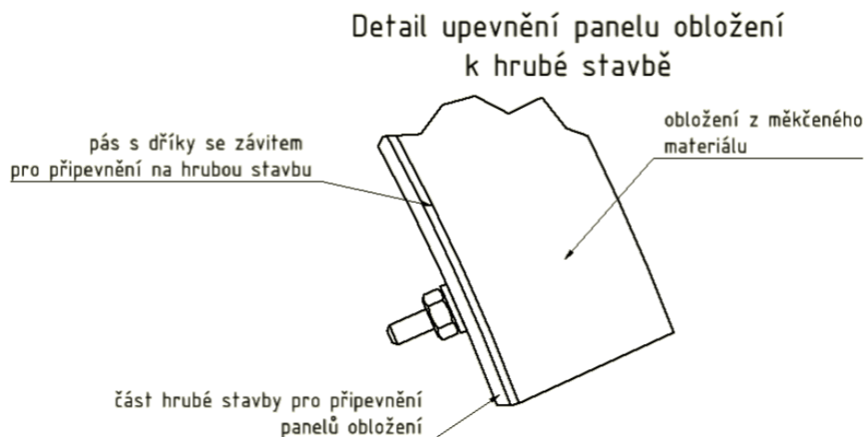
Obr. 6-8 Montáž panelu obložení na hrubou stavbu
