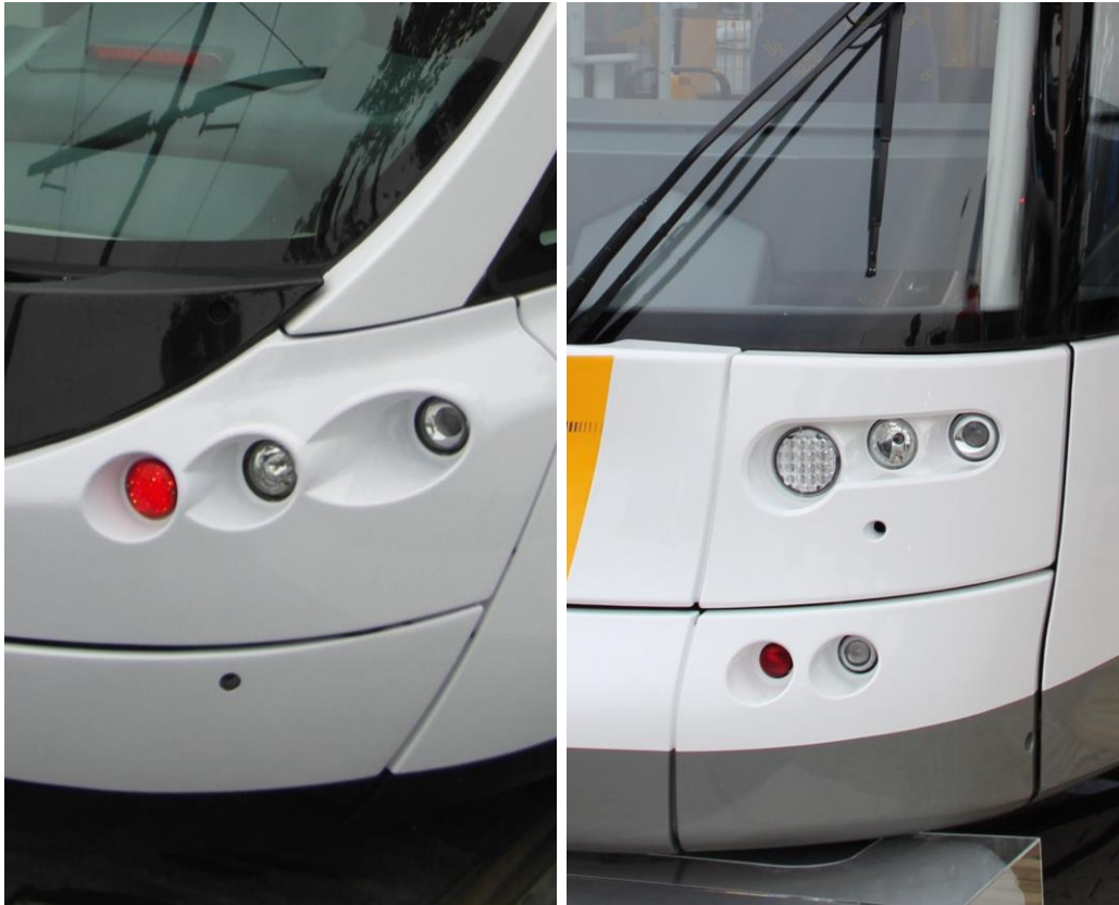
Obr. 5-5 Možnosti zapuštění světlometů
