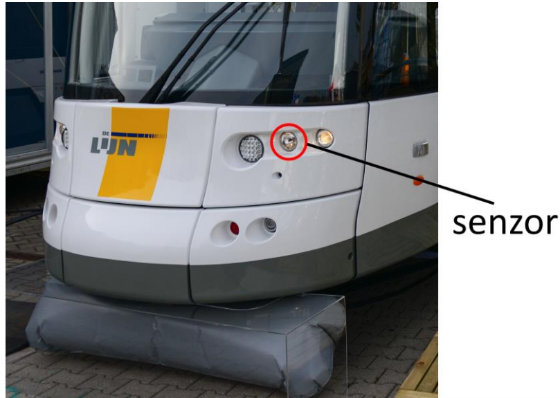
Obr. 5-14 Podjezdová ochrana formou nafukovacího vaku
