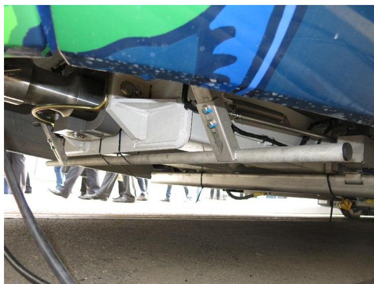
Obr. 5-15 Podjezdová ochrana formou nafukovacího vaku
