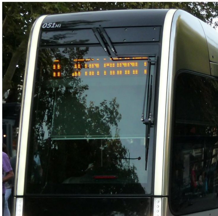
Obr. 5-8 Umístění mechanismu stěrače nad čelní sklo, ZDROJ: Alstom Citadis 402 Tours, https://en.wikipedia.org/wiki/Alstom_Citadis
