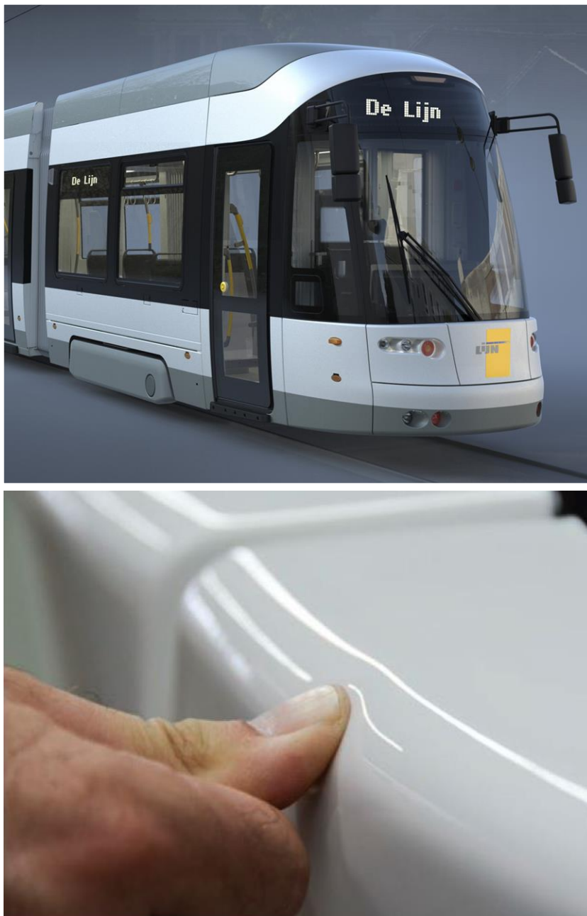
Obr. 6-5 Tramvaj Bombardier Flexity 2 s měkčenou maskou z PUR materiálu
