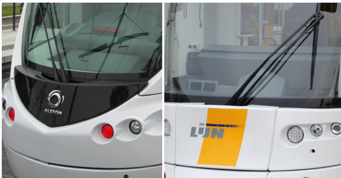
Obr. 5-7 Příklad zakrytí mechanismu stěrače, ZDROJ vlevo – Alstom Citadis 402 Tours, Francie, https://en.wikipedia.org/wiki/Alstom_Citadis vpravo – Bombardier Flexity 2, De Lijn https://nl.wikipedia.org/wiki/InnoTrans
