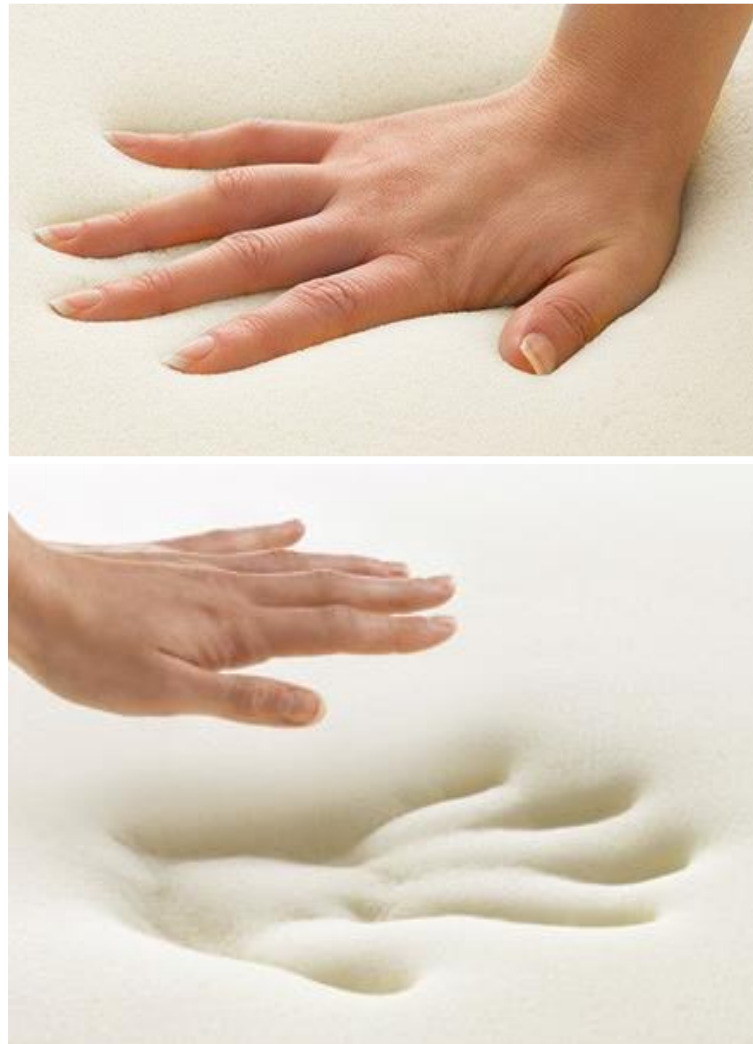
Obr. 6-6 Chování viskoelastické pěny
