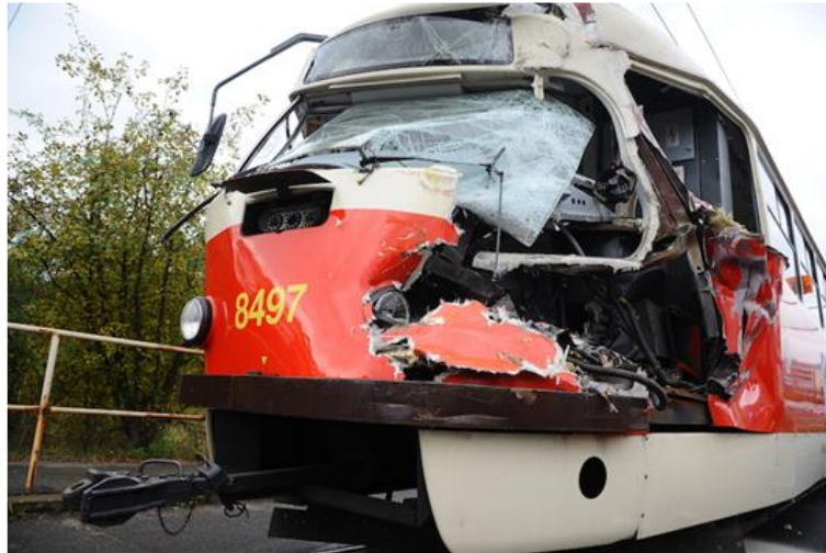
Obr. 6-7 Možnost porušení laminátového obložení při větší kolizi s vozidlem
