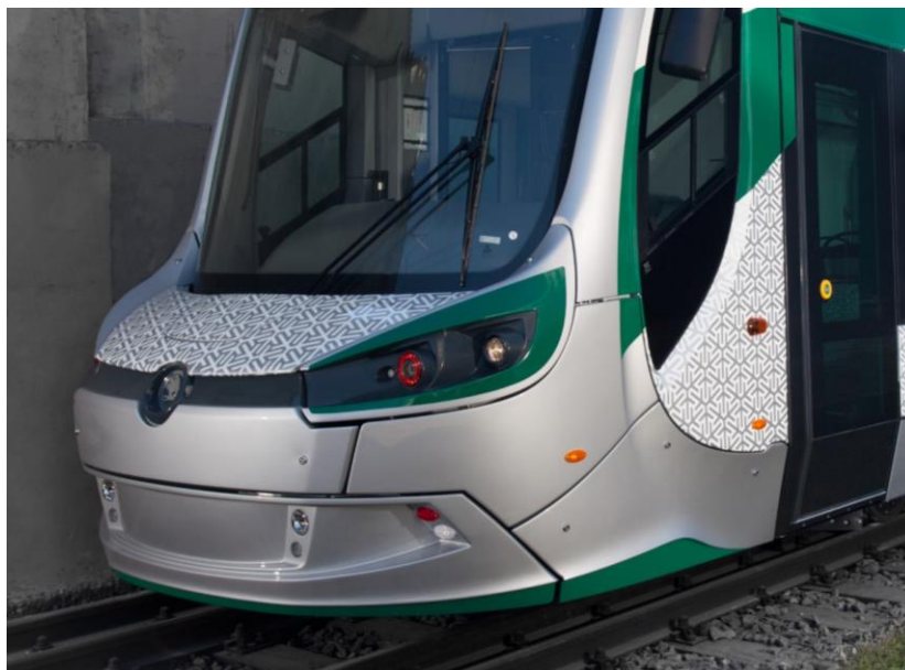
Obr. 5-11 Obložení čela vozu se zakrytým spřáhlem, ZDROJ
