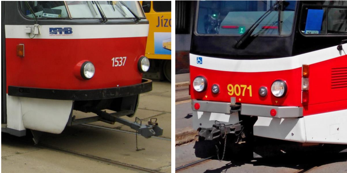
Obr. 5-10 Vozy bez zakrytí spřáhla, ZDROJ
