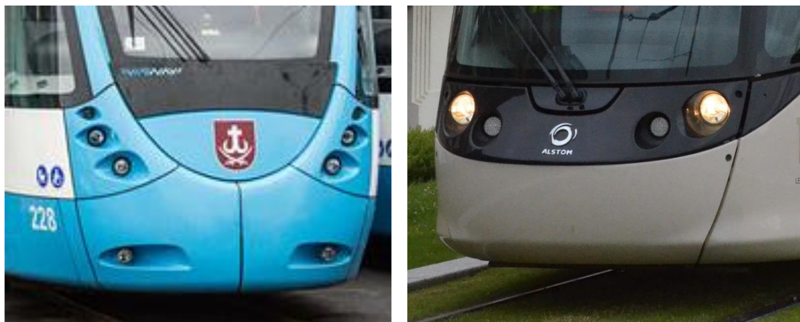
Obr. 6-3 Příklad dělení panelů obložení čela tramvaje,
