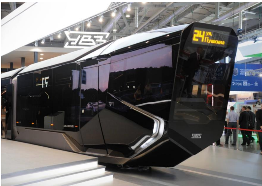
Obr. 5-3 Příklad negativní sklon čela vozidla
