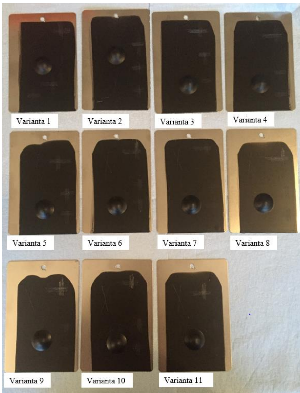
Obrázek 2 - Vzorok podrobené zkoušce hloubením, mřížkové zkoušce a zkoušce řezem ve tvaru X
