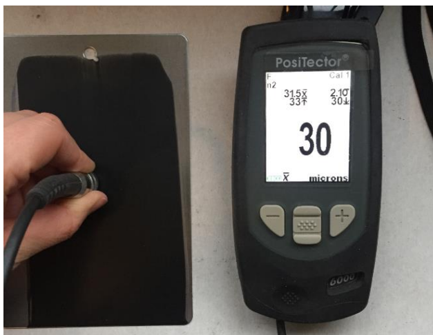
Obrázek 27 - Měření tloušťky povlaku přístrojem PosiTector 6000
