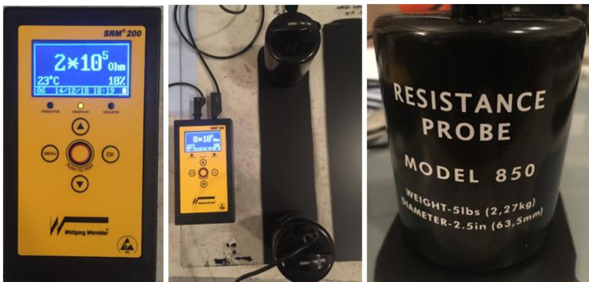
a) Přístroj SRM 200 b) Měření s připojením dvou senzorů c) Přídavné senzory Obrázek 33 - Měření elektrického odporu
